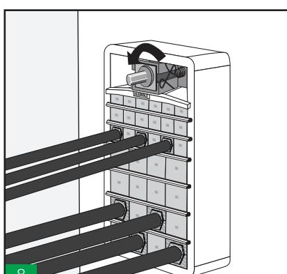
8 Apretar la herramienta de compresión hasta obtener suficiente espacio para colocar las piezas laterales de la empaquetadura.
