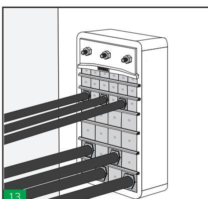
Realizar una inspección visual del pasamuro. El exclusivo sistema de codificación por colores de HTS permite que la instalación sea inspeccionada visualmente después de completarse y asegura la correcta correspondencia de las mitades del taco.
