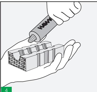
4 Lubricar todos los tacos ciegos y pasacable con el lubricante HTS.
