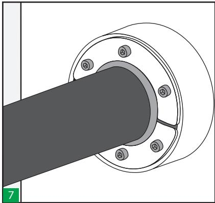
Ispezionare visivamente il passaggio, verificando che il passaggio HRST selezionato (identificato dal codice colore) si abbini al cavo/tubo e al manicotto installato, che sia completamente inserito nel manicotto e che non ci siano spazi tra il passaggio e il cavo/tubo.
