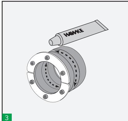
3 Lubrificare l'interno del passaggio HRST a contatto con il cavo/tubo e lubrificare leggermente la parte esterna a contatto con il manicotto.
