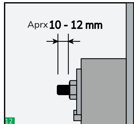
Stringere i dadi del modulo terminale in maniera alternata seguendo la sequenza sopra indicata per comprimere il passaggio e completare la sigillatura. Per un'installazione più facile, usare una chiave a cricchetto.
