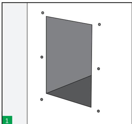
1 Tagliare un'apertura rettangolare per il telaio in base alla misura di H-DM da usare. (vedere tabella).
