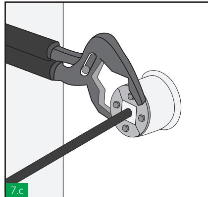
Deslizar las dos placas frontales juntas y mantenerlas fijas. Para una instalación más fácil, pueden usarse sujetacables, pernos o alicates ajustables para fijar dichas placas.
