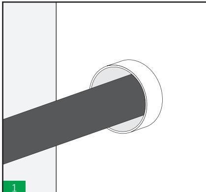
Comprobar el diámetro interior del casquillo y el diámetro exterior del cable/tubería para verificar que esta dentro del rango del HRST seleccionado. El código de colores de HTS HRST ayudara para una correcta selección.
