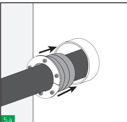
Insertar el HRST dentro del casquillo. Comprobar que el HRST esta completamente insertado en el casquillo, Las placas frontales deben de estar en contacto con el casquillo.
