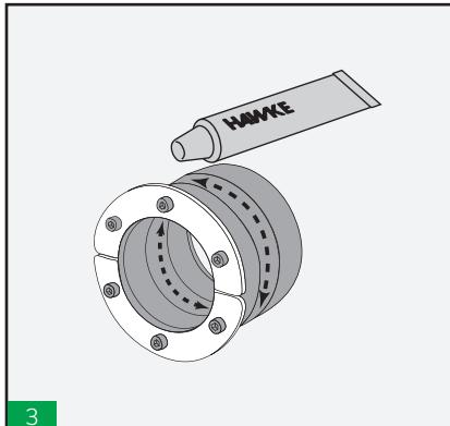
Lubricar el interior del HRST en contacto con el cable/tubería y lubricar ligeramente el exterior en contacto con el casquillo.
