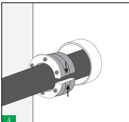
Abrir el HRST e instalarlo alrededor del cable/tubería.
