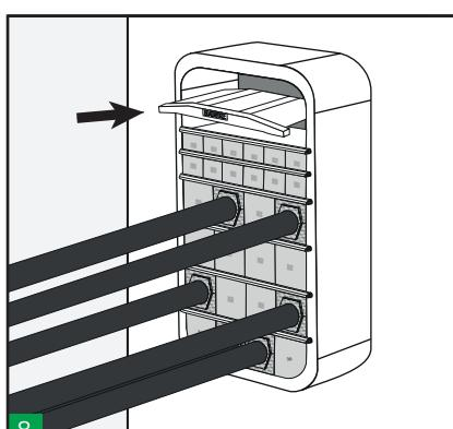
8 Inserire nel telaio l'ultima piastra di ancoraggio e la piastra di compressione prima dell'ultima fila di blocchetti (o prima se necessario). Verificare la superficie del telaio coperta dai blocchetti, controllando che tutta l'area utile per una certa misura di telaio (vedere la tabella) sia riempita di blocchetti.
