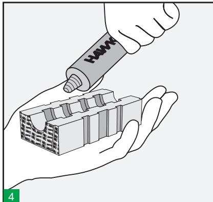
4 Lubrificare la superficie di tutti i blocchetti tolleranti e di riempimento usando il lubrificante HTS.
