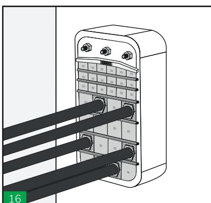
Realizar una inspección visual del pasamuro. El exclusivo sistema de codificación por colores de HTS permite que la instalación sea inspeccionada visualmente después de completarse y asegura la correcta correspondencia de las mitades del bloque.
