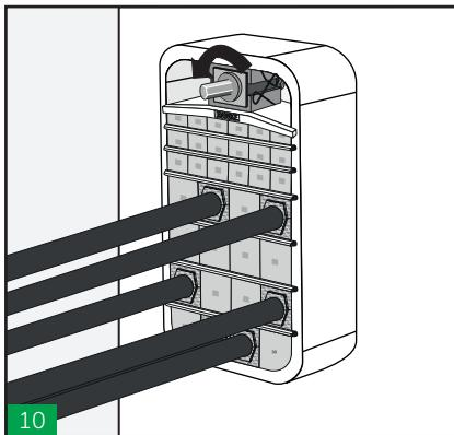
Apretar la herramienta de compresión hasta generar suficiente espacio para colocar las piezas laterales de la empaquetadura.
