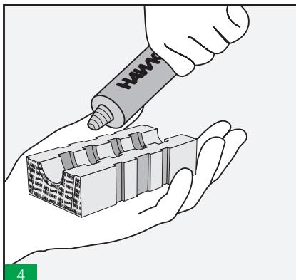
Lubricar todos los tacos ciegos y los pasacable con el lubricante HTS.
