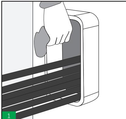
Asegurarse que el marco este limpio, pase los cables y tuberías a través del marco, ubicando los de mayor diámetro en la parte baja. (Nota: Emplear marco abierto para instalaciones con cable ya existentes).
