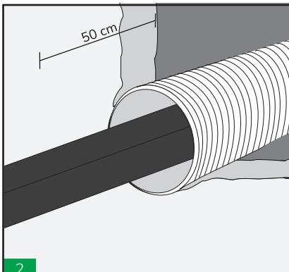
2 Confirme que los cables penetran la pared de forma perpendicular al menos 50 cm antes de llegar al tubo.
