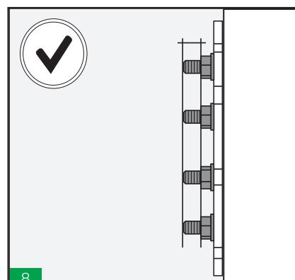
8 Realice una inspección visual final de la instalación, asegurando lo siguiente: apretado los tornillos de forma uniforme, el asiento de goma se ajusta perfectamente al cable y sale ligeramente a través de la placa delantera.
