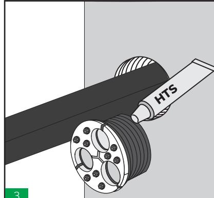
3 Lubrique el interior del HBRST donde entra en contacto con el cable, también lubrique el exterior del tubo donde contacta con ella.
