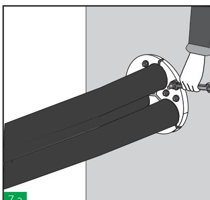
7.a Incremente la presión de los tornillos de forma gradual, 2mm aproximadamente cada vez, siguiendo la secuencia que se muestra en la ilustración. Continúe apretando los tornillos hasta que el sistema esté completamente comprimido para sellar el cable/la tubería de forma efectiva.
