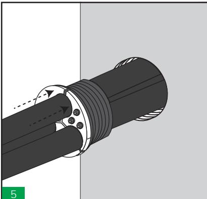
5 Inserte con cuidado el HBRST dentro del tubo. Asegure que el HBRST está completamente insertado para que las placas delanteras estén en contacto directo con la tubería.
