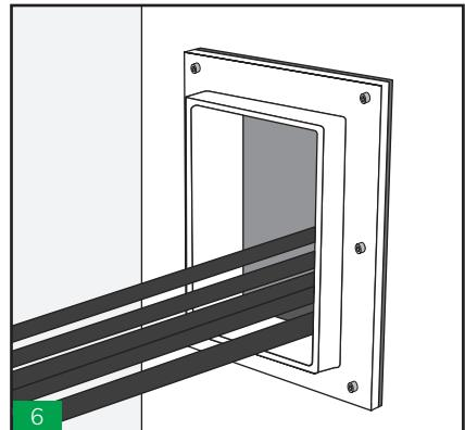
6 Tire los cables o tuberías a través del marco, ubicando los mas grandes en la parte inferior.
