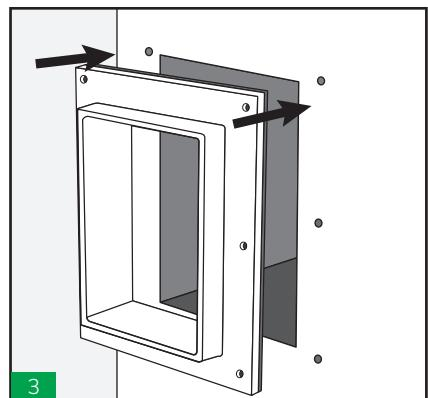
3 Instalar el marco en la abertura con el lado de la junta hacia el muro o estructura.
