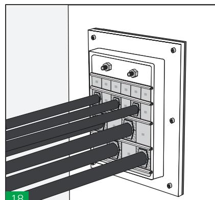
Realizar una inspección visual del pasamuro. El exclusivo sistema de codificación por colores de HTS permite que la instalación sea inspeccionada visualmente después de completarse y asegura la correcta colocación de las mitades del taco.
