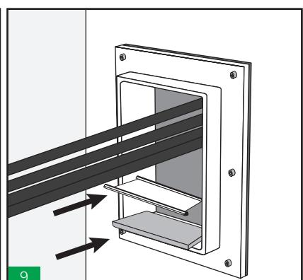
9 Antes de comenzar a sellar, colocar una tira de 5mm con la placa de separación en la parte inferior. Esto se incluye con el sistema de compresión.
