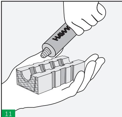
Lubricar todos los tacos ciegos y pasacable con el lubricante HTS.
