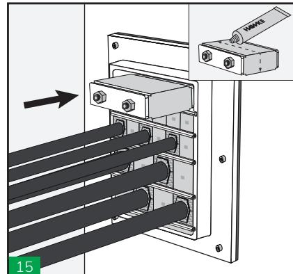
Insertar la ultima fila de tacos entre las ultimas placas de separación. Lubricar e insertar la empaquetadura final H-DM en la parte superior del marco.
