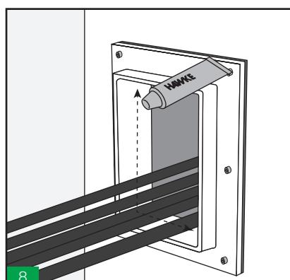
8 Lubricar la parte interna del marco. Asegurarse que las esquinas están bien lubricadas.
