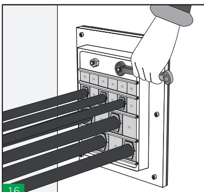
Apretar las tuercas del sistema de compresión en orden alterno para comprimir y completar el sellado.
