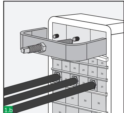
Rimuovere i dadi e la piastra di serraggio del sistema di compressione.
