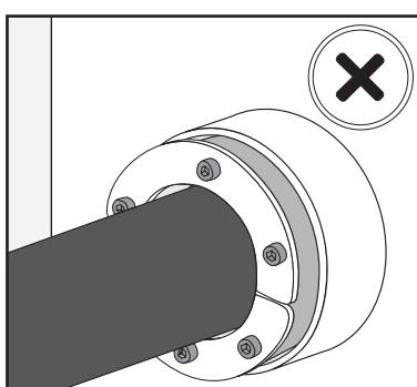
Verificare che il passaggio HRST sia completamente inserito nel manicotto/apertura.
