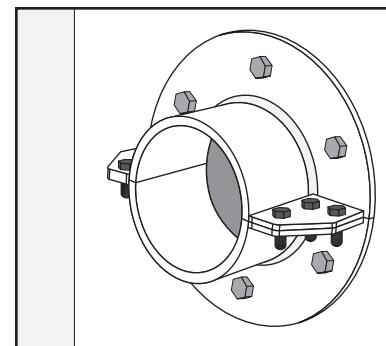
Comprobar el diámetro interior del casquillo y el diámetro exterior del cable/tubería para verificar que está dentro del rango de sellado del HRST seleccionado.
