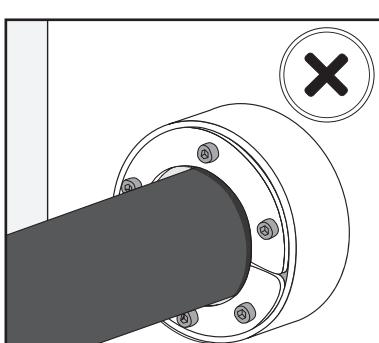
Comprobar que todos los tornillos han sido apretados de manera similar y no existen huecos entre los cables/tubería y el HRST.
