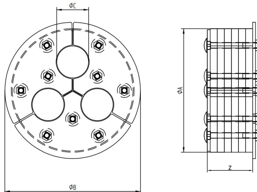
$\emptyset A$ - $B$  depende del diámetro interno del tubo.  $\emptyset C$  depende del tamaño de los cables.
