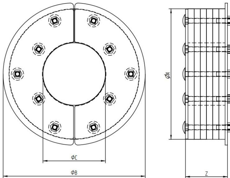
$\text{ØA-B}$  depende del diámetro interno del tubo. -  $\text{ØC}$  depende del tamaño de los cables.
