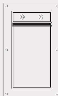
■ Opción 1 (Recomendada): Empaquetadura y una placa de separación se colocarán en la parte superior del marco sellado. El modulo o tira de relleno DM50 se situará en la parte inferior, con otra placa de separación sobre el (nunca entre la tira/modulo y el marco)
