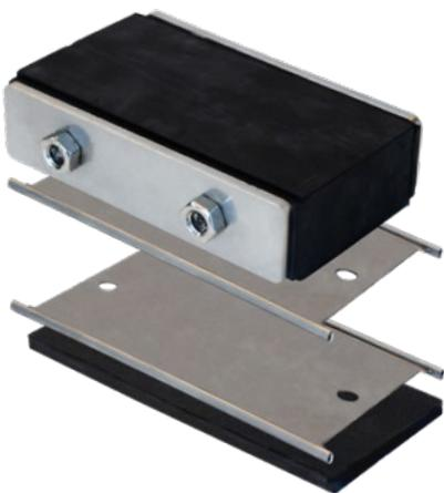
El sistema de compresión CSDM de HTS se usa junto con los marcos H-DM para comprimir y sellar la instalación de los cables y tacos DM del sistema. Este Kit incluye; la empaquetadura final, tira de relleno de 5mm y dos placas de separación. La tira de relleno de 5mm se puede instalar tanto en la parte superior como en la parte inferior de las filas de tacos en una abertura H-DM.
