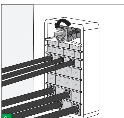
8 Avvitare l'attrezzo di compressione fino a creare uno spazio sufficiente per inserire gli elementi esterni del modulo terminale.
