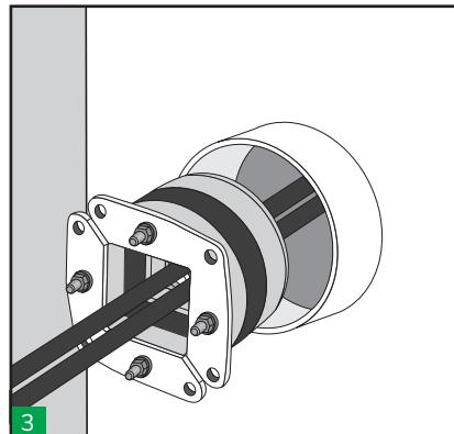
Inserire completamente il passaggio rotondo nel manicotto attorno ai cavi. Non applicare lubrificante sul manicotto o sull'esterno del passaggio. Se si usa la versione chiusa del Passaggio rotondo (HRT), il passaggio deve essere installato prima di far passare i cavi/tubi attraverso il manicotto o l'apertura.
