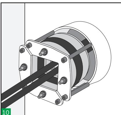
L'estrazione si ottiene rilasciando la compressione, ossia invertendo i passaggi 7 e 8 e avvitando viti M8 (non fornite) nei fori filettati su ogni angolo delle piastre anteriori. In questo modo si estraе il passaggio dal manicotto permettendone lo smontaggio.
