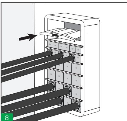
8 Inserire l'ultima piastra di ancoraggio e la piastra di compressione prima dell'ultima fila di blocchetti (o prima se necessario). Verificare che tutta l'area utile del telaio di questa misura (vedere la tabella alla pag. seguente) sia riempita di blocchetti.
