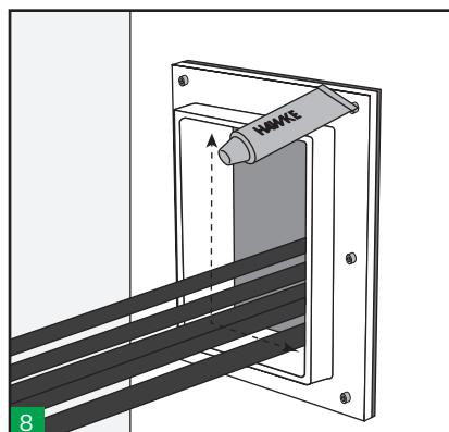
8 Lubrificare l'interno del telaio. Assicurarsi che gli angoli siano ben lubrificati.
