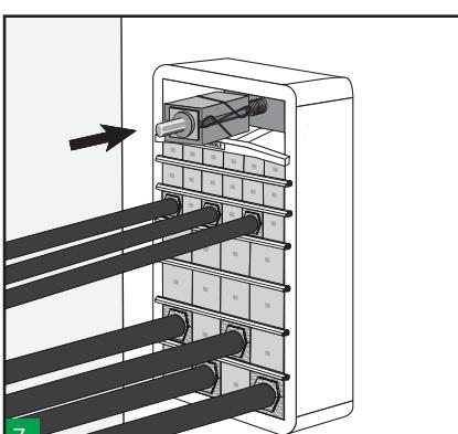
7 Inserire l'ultima fila di blocchetti tra l'ultima piastra di ancoraggio e la piastra di compressione. Inserire l'attrezzo di compressione sopra la piastra di compressione, al centro.
