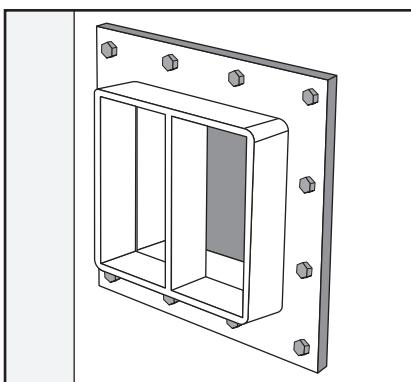
Verificare che nell'installazione sia stato usato un Telaio HTS, che sia stato installato correttamente (saldato/imbullonato) e che non abbia subito danni meccanici o da corrosione.
