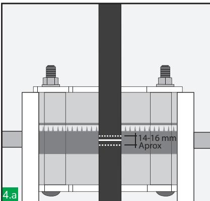
4.a Marcare ogni cavo in corrispondenza del centro del telaio e 7-8 mm su ogni lato da questo punto. Si raccomanda inoltre di marcire il cavo a livello di entrambe le estremità del telaio.
