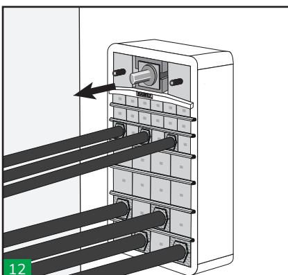
12 Inserire l'elemento centrale del modulo terminale insieme alla piastra anteriore.
