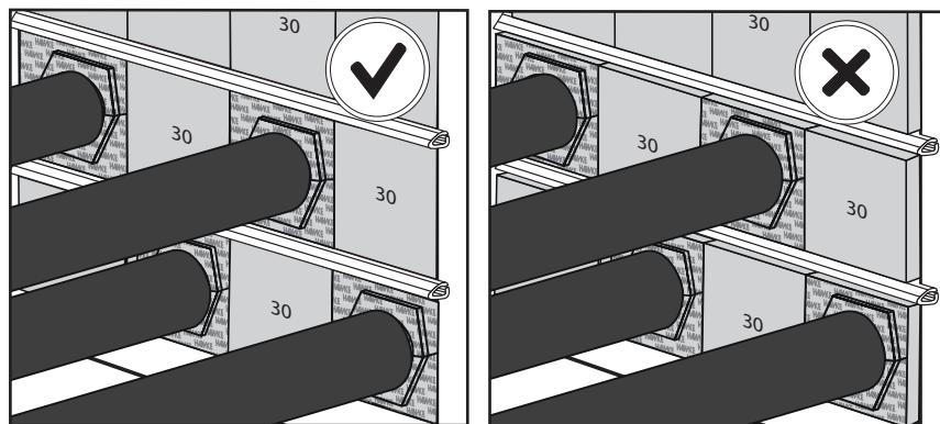
Verificare che sia stato usato il lubrificante HTS durante l'installazione.
