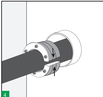
4 Aprire il passaggio HRST e installarlo intorno al cavo/tubo.
