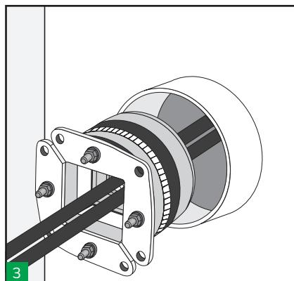
3 Inserire completamente il passaggio rotondo nel manicotto intorno ai cavi e aprire le due piastre anteriori (le piastre anteriori dei passaggi HRTO30, HRTO40 e HRTO50 sono fisse). Non applicare lubrificante sull'apertura o al di fuori del manicotto.
