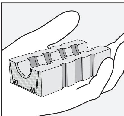
Misurare il diametro esterno del cavo e assicurarsi che rientri nella gamma di diametri indicata sulla parte anteriore del blocchetto o dal codice colore del blocchetto.
