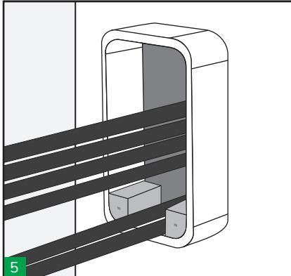
5 Inserire i blocchetti ad angoli arrotondati HF200/R20 o HF300/R20 negli angoli inferiori del telaio.
