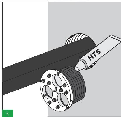
Lubrifica l'interno dell'HBRST nella parte in cui entra in contatto con il cavo e Lubrifica leggermente l'esterno dove entra in contatto con il tubo.
