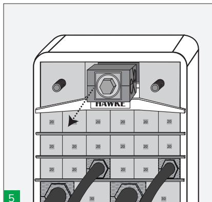
Inserire gli elementi laterali del modulo terminale. Successivamente, svitare l'attrezzo di compressione e rimuoverlo.
