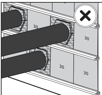
Verificare la presenza di una piastra di ancoraggio tra ciascuna fila di blocchetti e che non ci siano piastre di ancoraggio tra la fila di fondo e il telaio.
