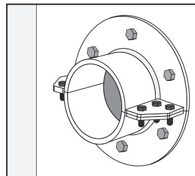
Verificare il diametro interno del manico e il diametro esterno di ciascun cavo/tubo per verificare che rientri nell'intervallo del passaggio HRST selezionato.
