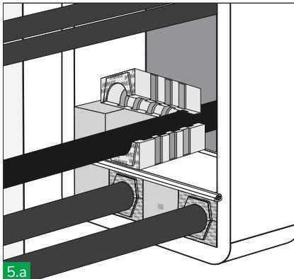
5.a Iniziare a riempire il telaio. Il codice colore vi aiuterà a installare correttamente i blocchetti. Tra uno strato di blocchetti e l'altro va sempre inserita una piastra di ancoraggio. I blocchetti non devono sporgere al di fuori dei bordi di ritenzione delle piastre di ancoraggio.
