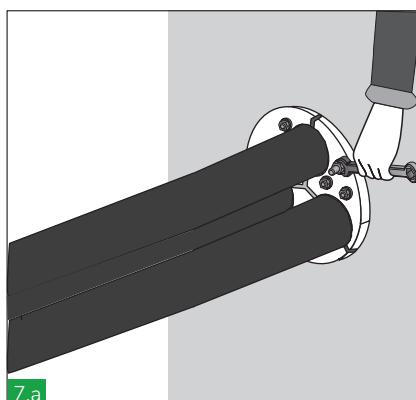
Stringi le viti gradualmente, circa 2 mm alla volta, seguendo la sequenza mostrata nell'immagine. Continua a stringere fino a quando il sistema è completamente compresso per sigillare efficacemente il cavo/tubo.
