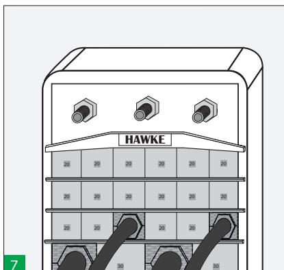
Stringere i dadi sul modulo terminale in maniera alternata seguendo la sequenza sopra indicata per comprimere il passaggio e garantirne la tenuta. Per un'installazione più facile, usare una chiave a cricchetto. Per assicurare la tenuta, devono fuoriuscire circa 10-12mm di filettatura da ogni bullone.
