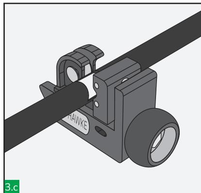
L'attrezzo di rimozione della guaina del cavo EMC può aiutarvi a ridurre i tempi ed evitare di danneggiare lo schermo del cavo durante il taglio.
