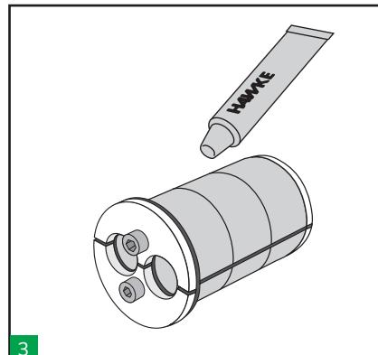
3 Lubrificare l'interno del passaggio HRST a contatto con i cavi e lubrificare leggermente la parte esterna a contatto con il manicotto.
