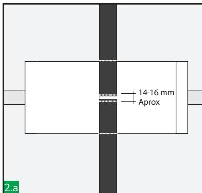
Marcare ogni cavo in corrispondenza del centro del telaio e 7-8 mm su ogni lato da questo punto. Si raccomanda inoltre di marcire il cavo a livello di entrambe le estremità del telaio. Lo strumento di marcatura EMC può aiutarvi a ridurre i tempi ed effettuare una marcatura corretta.
