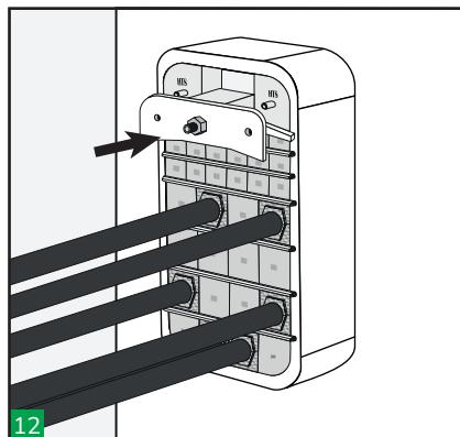
11.a Inserire gli elementi esterni del modulo terminale. Successivamente, svitare lo strumento di compressione e rimuoverlo.
