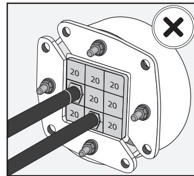
Verificare che ci sia un numero sufficiente di blocchetti installati all'interno del telaio per coprire l'area utile definita per ogni misura di passaggio.
