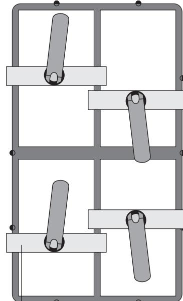
■ L'attrezzo di fissaggio per saldature (si veda a pag. 80) può essere usato per evitare deformazioni durante la saldatura.
