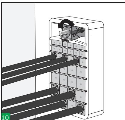
10 Avvitare l'attrezzo di compressione fino a creare uno spazio sufficiente per inserire gli elementi esterni del modulo terminale.
