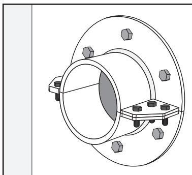
Verificare che nell'installazione sia stato usato un Manicotto HTS, che sia stato installato correttamente (saldato/imbullonato) e che non abbia subito danni meccanici o da corrosione.
