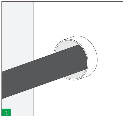
1 Verificare il diametro interno del manicotto e il diametro esterno del cavo/tubo per verificare che rientri nella tolleranza del passaggio HRST selezionato. Il codice colore faciliterà la corretta selezione.
