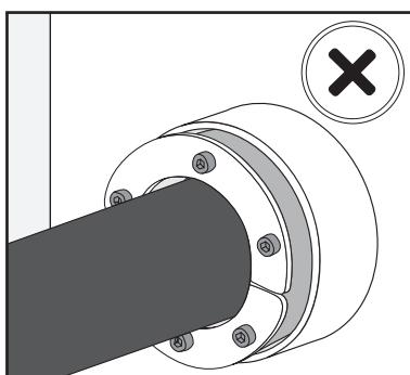
Verificare che il passaggio HRST sia completamente inserito nel manicotto/apertura.
