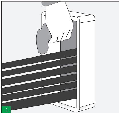
1 Assicurarsi che il telaio sia pulito, dopodiché posare i cavi o i tubi attraverso di esso, posizionando i più grandi in basso. (Nota: usare telai con estremità aperta in caso di installazione attorno a cavi/tubi già posati)
