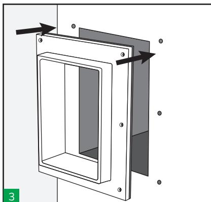
3 Installare il telaio nell'apertura con il lato della guarnizione verso il quadro.
