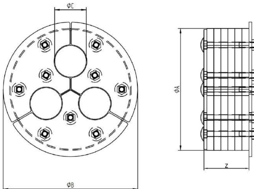
$\varnothing A-B$  dipende dal diametro interno del tubo corrugato. -  $\varnothing C$  dipende dalla dimensione dei cavi.
