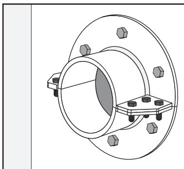
Verificare che nell'installazione sia stato usato un Manicotto HTS, e che sia stato installato correttamente (saldato/ imbullonato) e che non abbia subito danni meccanici o da corrosione.
