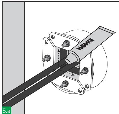
Lubrificare l'interno del passaggio HRT e di tutti i blocchetti tolleranti e di riempimento usando il lubrificante HTS. Aprire le due piastre anteriori (le piastre anteriori dei passaggi HRT030, HRT040 e HRT050 sono fisse).
