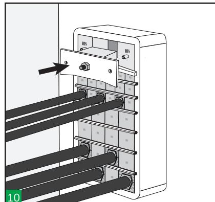
11.a Inserire gli elementi esterni del modulo terminale. Successivamente, svitare l'attrezzo di compressione e rimuoverlo.
