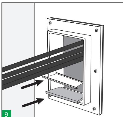
9 Prima di iniziare a inserire i blocchetti, posizionare la striscia di riempimento da 5mm con una piastra di ancoraggio nella parte inferiore del telaio. Queste parti sono incluse nel sistema di compressione.
