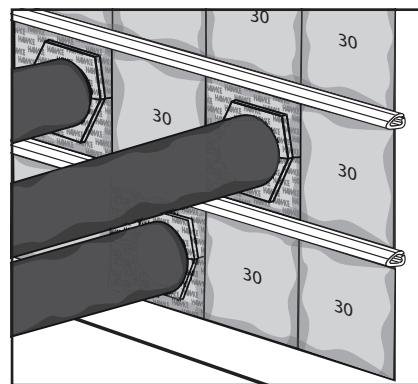
Verificare che ci sia un numero sufficiente di blocchetti installati all'interno del telaio per coprire l'area di passaggio definita per ogni misura di telaio.
