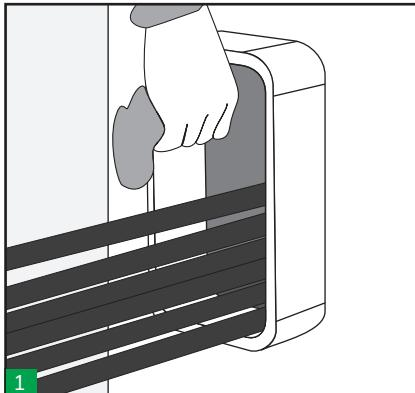
1 Assicurarsi che il telaio sia pulito, dopodiché posare i cavi o i tubi attraverso di esso, posizionando i più grandi in basso. (Nota: usare telai con estremità aperta per installarli attorno a cavi/tubi già posati)
