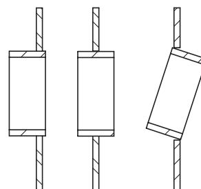
■ Posizioni saldatura a ponte
