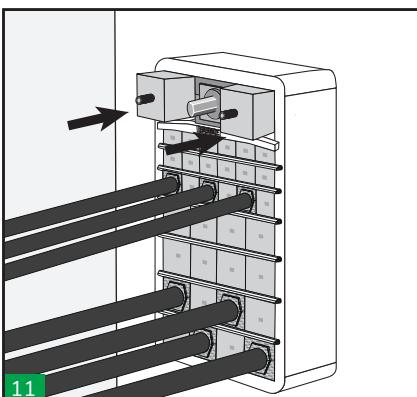
11 Inserire gli elementi esterni del modulo terminale. Successivamente, svitare lo strumento di compressione e rimuoverlo.
