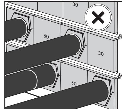
Verificare che sia stato usato il lubrificante HTS durante l'installazione.
