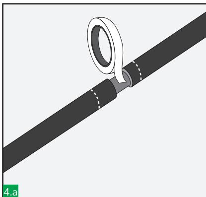
Usare il nastro di rame avvolgendolo strettamente attorno allo schermo esposto fino a quando non si è pareggiato il diametro esterno del cavo con guaina. Ripetere questo passaggio per ogni cavo.
