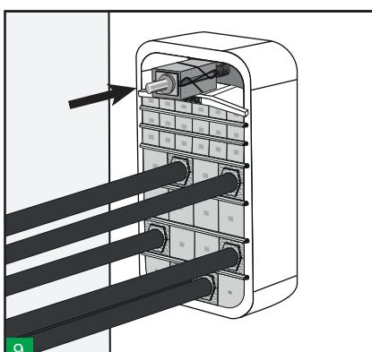
9 Inserire l'ultima fila di blocchetti tra l'ultima piastra di ancoraggio e la piastra di compressione. Inserire l'attrezzo di compressione sopra la piastra di compressione, al centro.
