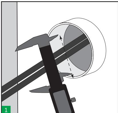
Misurare il diametro interno del manicotto per assicurare che rientri nella tolleranza del passaggio rotondo da usare.
