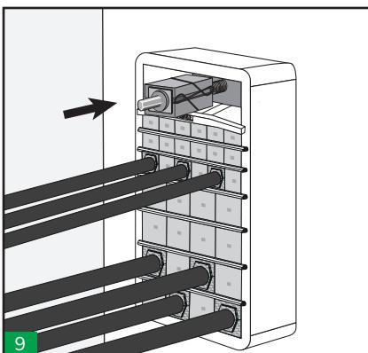
9 Inserire l'ultima fila di blocchetti tra l'ultima piastra di ancoraggio e la piastra di compressione. Inserire l'attrezzo di compressione in cima, al centro della piastra di compressione.
