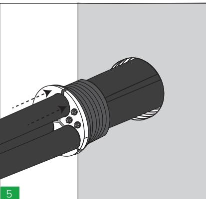
Inserisci con attenzione l'HBRST nel tubo. Assicurati che l'HBRST sia completamente inserito in modo che le piastre frontali siano a diretto contatto con il tubo corrugato.
