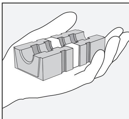
Misurare il diametro esterno del cavo e assicurarsi che rientri nella gamma di diametri indicata sulla parte anteriore del blocchetto.
