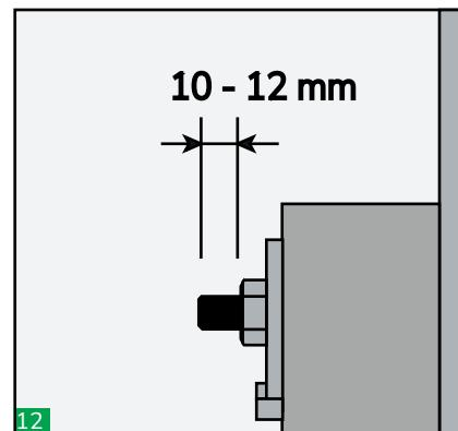
Stringere i dadi del modulo terminale in maniera alternata seguendo la sequenza sopra indicata per comprimere il passaggio e completare la sigillatura. Per un'installazione più facile, usare una chiave a cricchetto.
