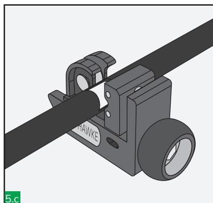
5.b L'attrezzo di rimozione della guaina del cavo EMC può aiutarvi a ridurre i tempi ed evitare di danneggiare lo schermo del cavo durante il taglio.v
