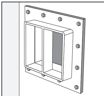
Verificare che nell'installazione sia stato usato un Telaio HTS, e che sia stato installato correttamente (saldato/imbullonato) e che non abbia subito danni meccanici o da corrosione.
