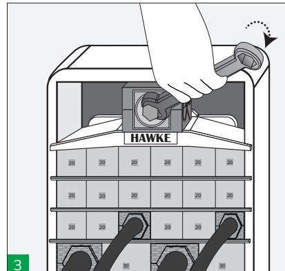
Una volta centrato, iniziare ad avvitare l'attrezzo di compressione che spingerà sulla piastra di compressione.
