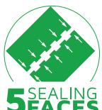
Questa caratteristica permette una tolleranza fino a 4 mm sui diametri dei cavi/tubi nello stesso blocchetto, senza richiedere alcuna modifica del blocchetto durante l'installazione.
