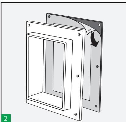
2 Rimuovere la protezione e posizionare la guarnizione sul telaio in alluminio.
