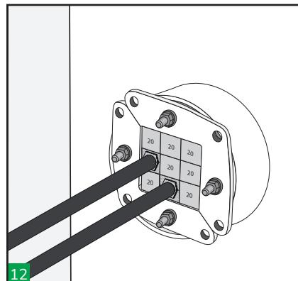
Stringere i dadi di circa 2 mm a ogni mandata in maniera alternata, applicando uguale pressione a entrambe le piastre. Deve fuoriuscire un minimo di 10 mm di filettatura da ogni bullone. Per un'installazione più facile, usare una chiave a cricchetto.
