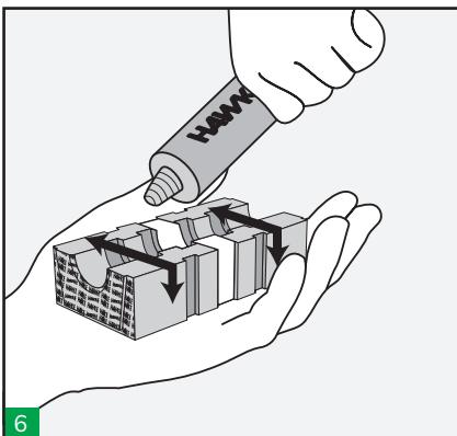
6 Lubrificare leggermente tutti i blocchetti tolleranti e di riempimento usando il lubrificante HTS e facendo attenzione a non contaminare il rame sui blocchetti e sui cavi.
