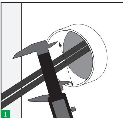
1 Misurare l'interno del manicotto per assicurare che rientri nel campo di tolleranza del passaggio rotondo da usare.
