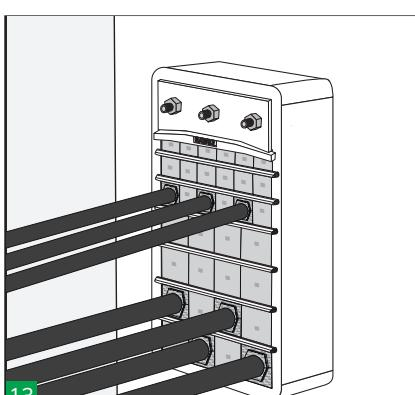
13 Ispezionare visivamente il passaggio. L'esclusivo codice colore HTS permette di ispezionare visivamente l'installazione una volta completata verificando che le metà dei blocchetti corrispondano.
