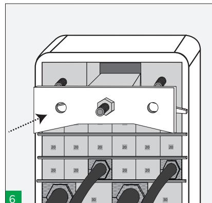
Inserire l'elemento centrale del modulo terminale insieme alla piastra anteriore.
