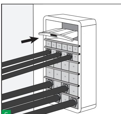
6 Inserire nel telaio l'ultima piastra di ancoraggio e la piastra di compressione prima dell'ultima fila di blocchetti (o prima se necessario). Verificare la superficie del telaio coperta dai blocchetti, controllando che tutta l'area utile per una certa misura di telaio (vedere la tabella) sia riempita di blocchetti.
