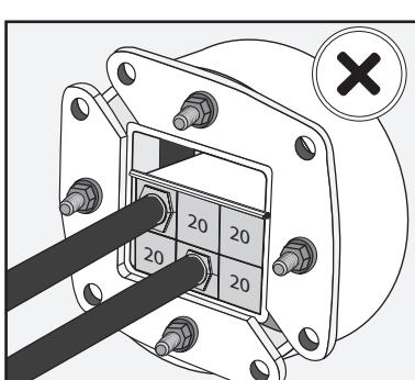
Verificare che non siano state usate piastre di ancoraggio nell'installazione.
