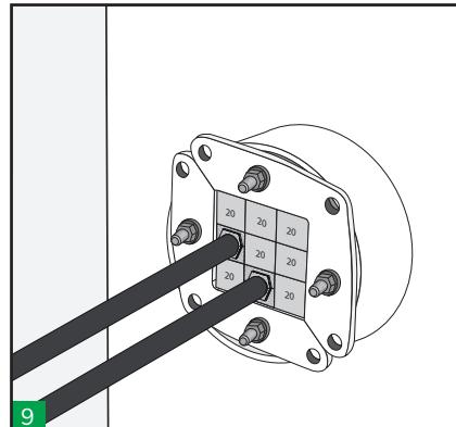
Stringere i dadi di circa 2 mm a ogni passata in maniera alternata, applicando uguale pressione a entrambe le piastre. Deve fuoriuscire un minimo di 10 mm di filettatura da ogni bullone. Per un'installazione più facile, usare una chiave a cricchetto.
