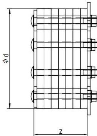
$\text{ØA-d}$  depende del diámetro interno del tubo.  $\square W$  depende de la cantidad y el tamaño de los cables.
