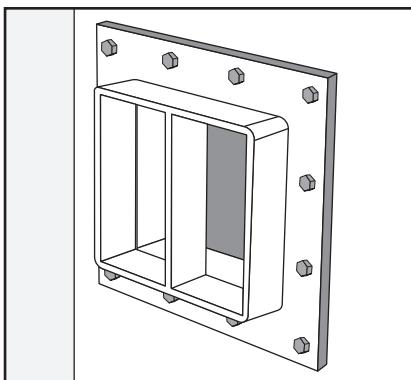
Comprobar que el marco HTS que ha sido empleado en la instalación esta debidamente instalado (Atornillado/soldado) y que este no tiene daños mecánicos o de corrosión.
