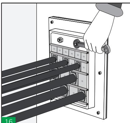
16 Apretar las tuercas del sistema de compresión en orden alterno para comprimir y completar el sellado.
