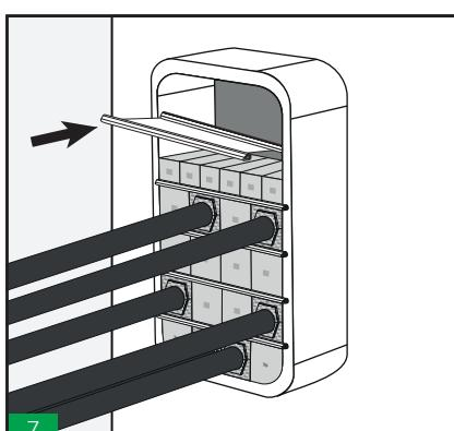
Instalar siempre una placa de separación entre cada fila de bloques. Los tacos no deben de sobrepasar los bordes de retención en las placas de separación.
