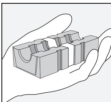
Medir el diámetro exterior del cable y asegurarse que el diámetro del cable /tubería entra dentro del rango marcado en la parte frontal del taco.
