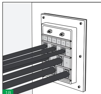
18 Realizar una inspección visual del pasamuro. El exclusivo sistema de codificación por colores de HTS permite que la instalación sea inspeccionada visualmente después de completarse y asegura la correcta colocación de las mitades del taco.
