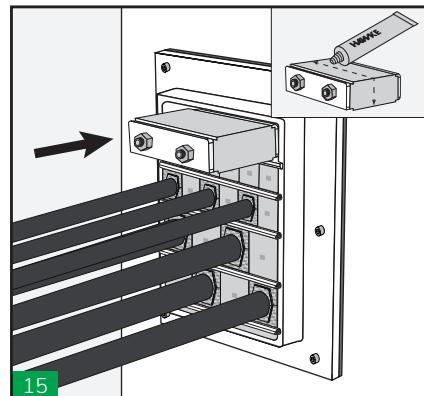
15 Insertar la ultima fila de tacos entre las ultimas placas de separación. Lubricar e insertar la empaquetadura final H-DM en la parte superior del marco.
