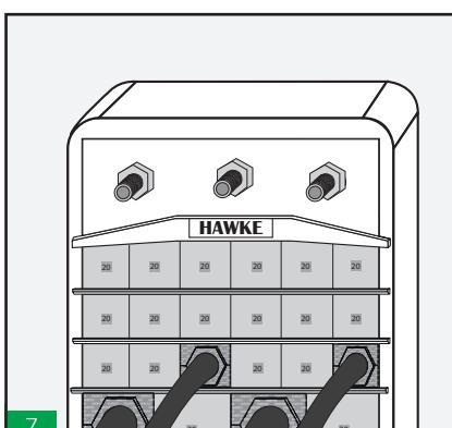
**7** Apriete las tuercas de la empaquetadura de forma alterna siguiendo la secuencia mostrada, para comprimir correctamente y completar el sellado. Utilizar una llave para una instalación más fácil. Aproximadamente deben de verse entre 10-12 mm de rosca en cada tornillo para garantizar un sellado óptimo.
