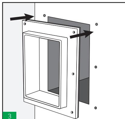
Instalar el marco en la abertura con el lado de la junta hacia el muro o estructura.
