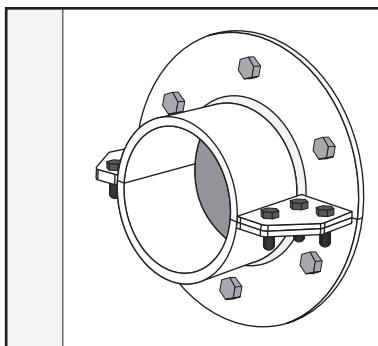
Comprobar que el casquillo HTS que ha sido empleado en la instalación esta debidamente instalado (Atornillado/ soldado) y que este no tiene daños mecánicos o de corrosión.
