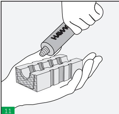
11 Lubricar todos los tacos ciegos y pasacable con el lubricante HTS.
