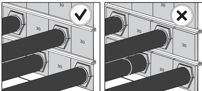
Compruebe que el Lubricante HTS ha sido utilizado durante la instalación.
