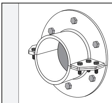
Comprobar que el casquillo HTS que ha sido empleado en la instalación está debidamente instalado (Atornillado/ soldado) y que este no tiene daños mecánicos o de corrosión.
