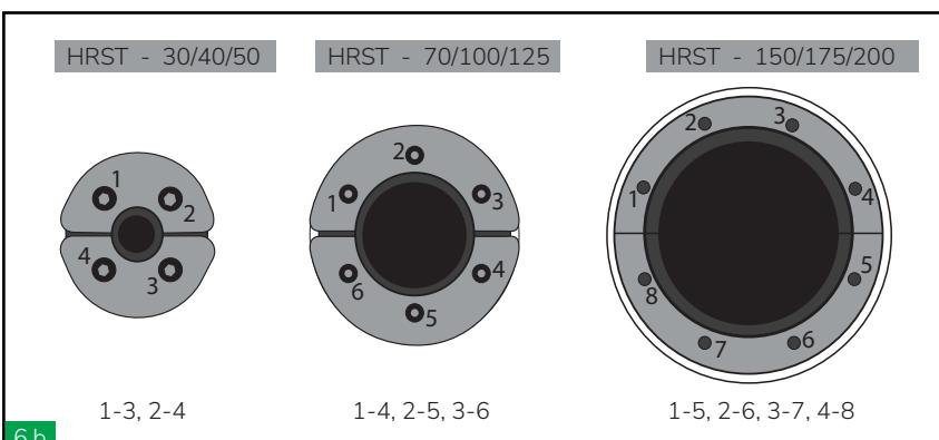
Apretar los tornillos. El atornillado se tiene que realizar a una vuelta de tornillo por vez, siguiendo la siguiente secuencia hasta que el sistema este comprimido para sellar el cable/tubería.
