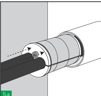
5.a Insertar el HRST dentro del casquillo. Comprobar que el HRST esta completamente metido dentro del casquillo, la parte frontal debe estar en contacto con el casquillo.
