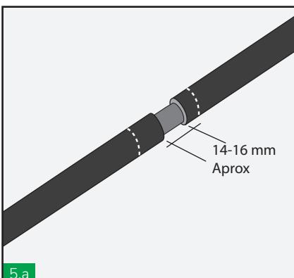
Cortar y retirar la cubierta del cable entre las dos marcas centrales, para poder ver la parte conductora del cable.
