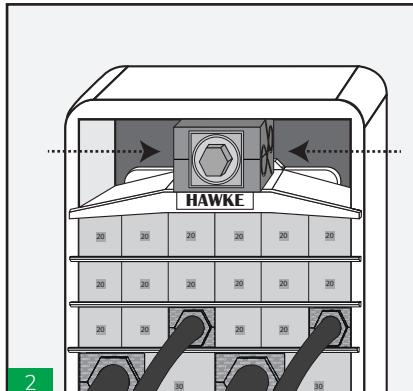
**2** La herramienta de compresión debe introducirse centrada en el marco, tanto en anchura como en profundidad, ya que de lo contrario la compresión del sistema no estaría equilibrada de manera que las piezas finales de la empaquetadura final no entrarían y sería necesario apretar en exceso la herramienta pudiendo dañarse.
