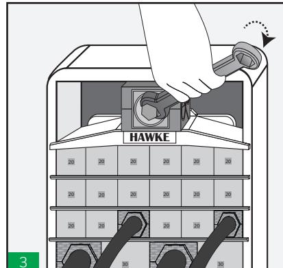
**3** Una vez centrado, comenzamos a apretar la herramienta de compresión la cual hará presión en la placa de compresión.
