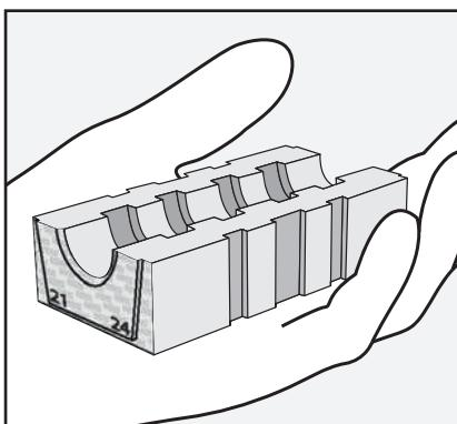
Mida el diámetro exterior del cable y asegúrese de que está dentro del rango de sellado del taco, estos están marcados en el frente del taco y por el código de color.
