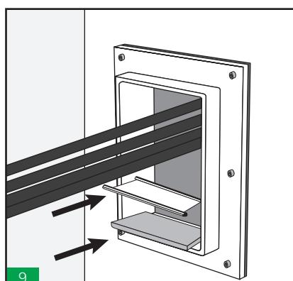
Antes de comenzar a sellar, colocar una tira de 5mm con la placa de separación en la parte inferior. Esto se incluye con el sistema de compresión.
