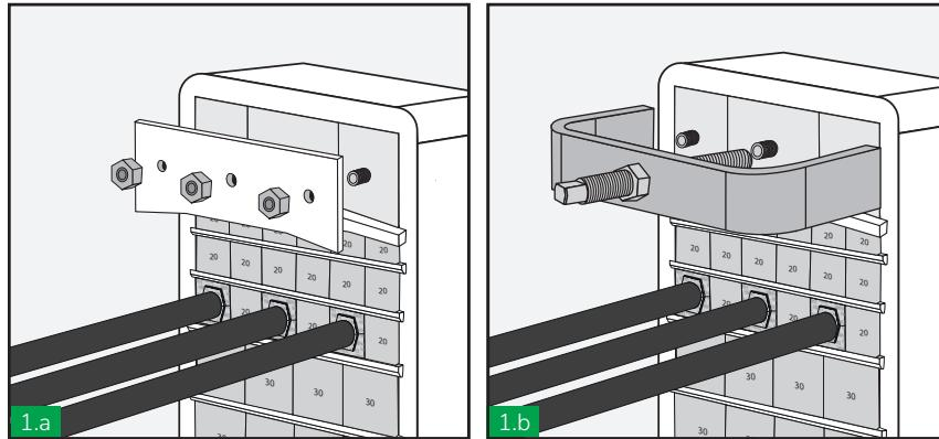
Retire las tuercas y la placa frontal de la empaquetadura.
