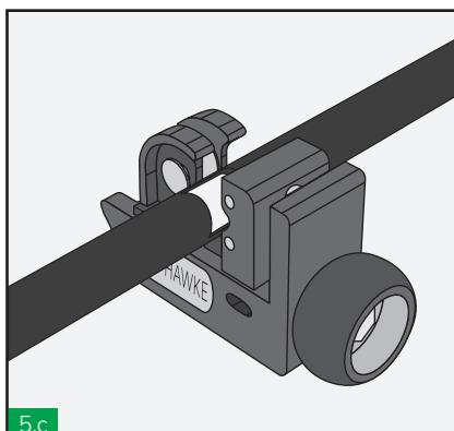
La herramienta para el corte de cubierta de cable EMC ayuda reduciendo el tiempo y asegurando un corte correcto.
