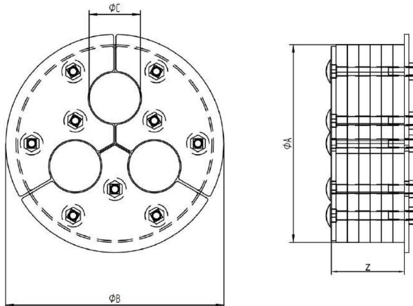
$\varnothing A-B$  depende del diámetro interno del tubo.  $\varnothing C$  depende del tamaño de los cables.
