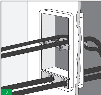
La Clamp Tool puede usarse para sujetar los cables en la parte superior del marco, permitiendo que la instalación de los tacos sea más sencilla.
