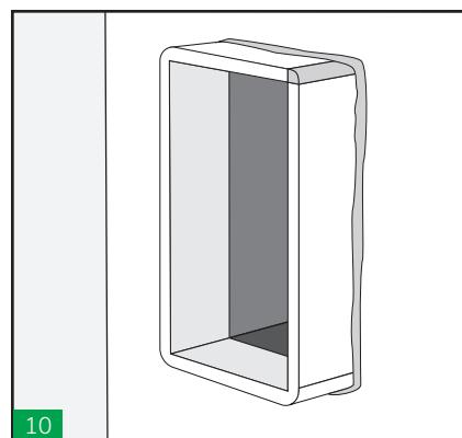
10 Suelde el marco en su posición de acuerdo con las instrucciones de soldadura del marco rectangular HMX y selle el marco según la guía de instalación del sistema rectangular estándar.
