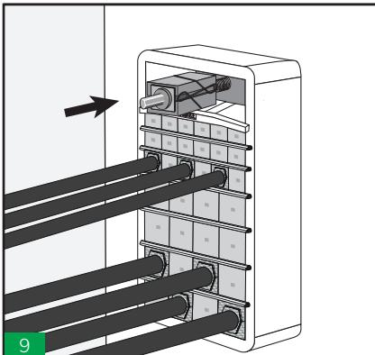
9 Insertar la ultima fila de tacos entre la placa de separación y la placa de compresión. Insertar la herramienta de compresión sobre la placa de compresión en el centro de esta.
