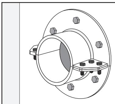
Comprobar que el marco HTS que ha sido empleado en la instalación está debidamente instalado (Atornillado/ soldado) y que este no tiene daños mecánicos o de corrosión.
