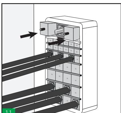
11 Colocar las piezas laterales. Después, afloje la herramienta de compresión y extrágala.
