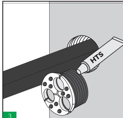
3 Lubrique el interior del HBRST donde entra en contacto con el cable, también lubrique el exterior del tubo donde contacta con ella.
