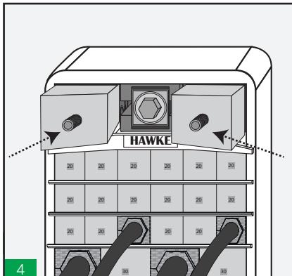
**4** Una vez centrado, comenzamos a apretar la herramienta de compresión la cual hará presión en la placa de compresión.
