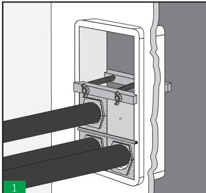
La Clamp Tool se puede usar para sujetar los cables en su lugar cuando una instalación no está completamente terminada.
