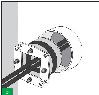
3 Insertar el marco circular por completo dentro del casquillo / abertura rodeando los cables. No se debe aplicar lubricante a la abertura o por fuera del marco. Si se emplease la versión cerrada de marco circular (HRT), este debería ser instalado previamente a colocar los cables / tuberías a través del casquillo o abertura.
