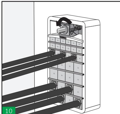
10 Apretar la herramienta de compresión hasta obtener suficiente espacio para colocar las piezas laterales de la empaquetadura.
