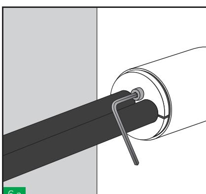
6.a Apretar los tornillos. El atornillado se tiene que realizar a una vuelta de tornillo por vez, siguiendo la siguiente secuencia hasta que el sistema este comprimido para sellar el cable/tubería.
