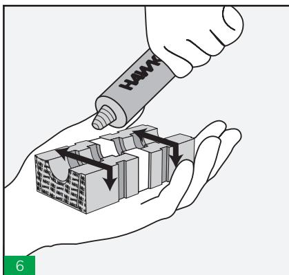
6 Lubricar ligeramente los tacos pasacable y tacos ciegos con el lubricante HTS, teniendo cuidado de no contaminar las zonas de cobre del cable o de los tacos.
