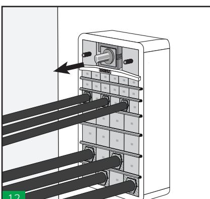
12 13 Insertar la pieza central de la empaquetadura con la placa frontal.
