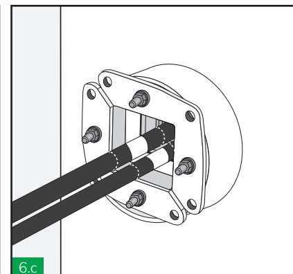
Envolver el cable expuesto con cinta de cobre para recuperar el diámetro exterior del cable.
