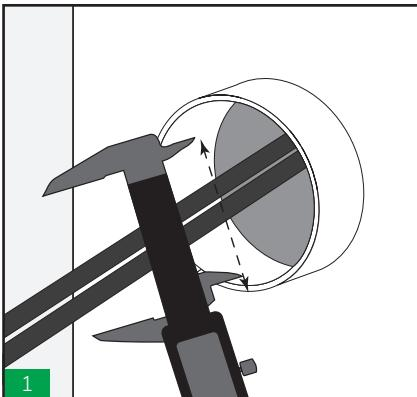
Medir el interior de la abertura de tubería para asegurarse de que está dentro de la tolerancia del marco circular que se utilizará.
