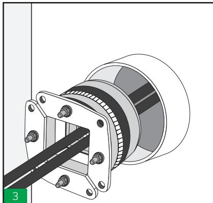
Insertar el marco circular por completo dentro del casquillo, rodeando los cables y separando las dos placas frontales. (HRTO30, HRTO40 Y HRTO50 tienen placas frontales fijas). No se debe aplicar lubricante a la abertura o fuera del marco.
