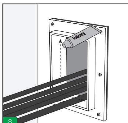
Lubricar la parte interna del marco. Asegurarse que las esquinas están bien lubricadas.
