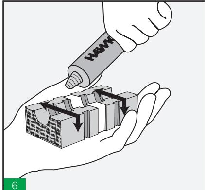
6 Lubricar ligeramente los tacos pasacable y tacos ciegos con el lubricante HTS, teniendo cuidado de no contaminar las zonas de cobre del cable o de los tacos.
