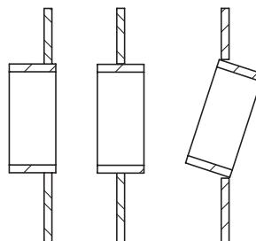
2. Realice una soldadura por puntos en el lado frontal, fijando el casquillo en la abertura recortada:
