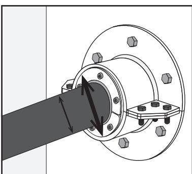
Comprobar que el diámetro interior del casquillo y el exterior del cable/tubería para verificar que está dentro del rango del HRST seleccionado.
