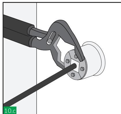
Deslizar las dos placas frontales y mantenerlas juntas. Hay que asegurar que todos los tacos están localizados sin sobrepasar el borde de retención. Para una instalación más sencilla, pueden usarse bridas, tornillos o alicates ajustables para fijar dichas placas.
