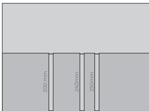
Las profundidades pueden ajustarse en obra cortando a la longitud requerida, gracias a las ranuras que facilitan el corte directamente en el lugar de construcción.
