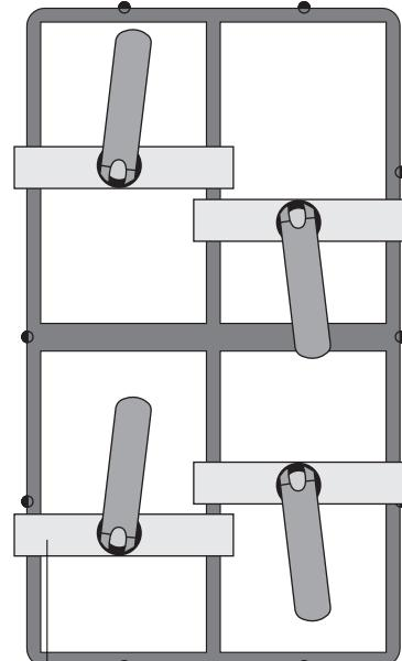
■ Herramienta de Soldadura (Ver pág. 83 del catálogo) puede usarse para evitar la deformación durante la soldadura.
