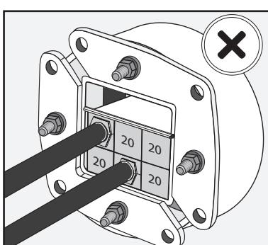
Comprobar que no se han usado placas de separación en la instalación.
