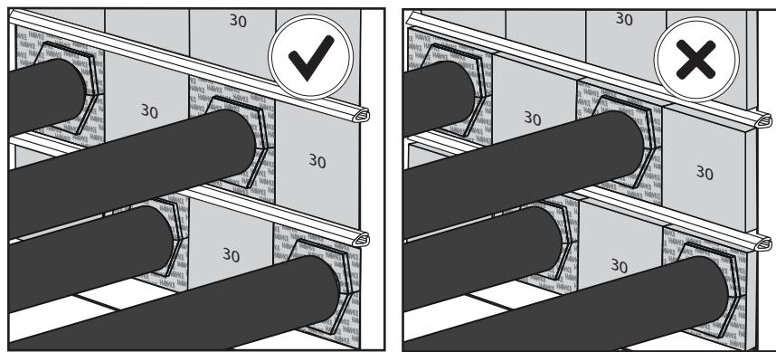
Comprobar que el lubricante HTS ha sido usado durante la instalación.
