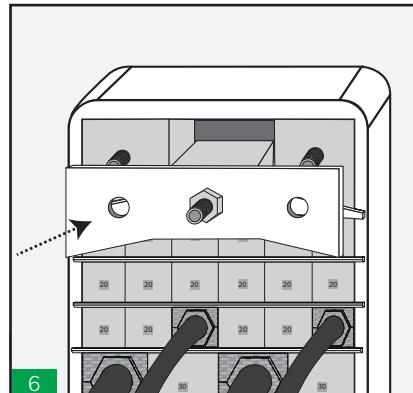
**6** Inserte la pieza central de la empaquetadura junto con la placa frontal.
