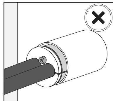
Comprobar que el lubricante HTS se ha usado en la instalación.
