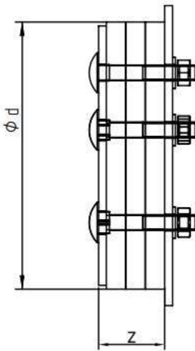
$\text{Ø}_A$ -d depende del diámetro interno del tubo.  $\text{Ø}_C$  depende del tamaño de los cables.
