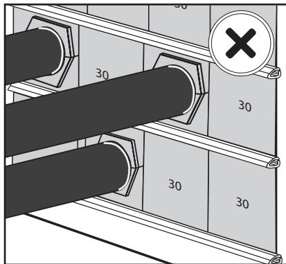
Verifique que haya una placa de separación entre cada fila de tacos y que no haya placa de separación entre la fila inferior de tacos y el marco.
