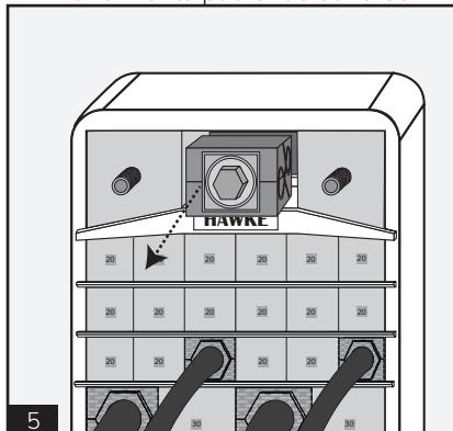
**5** Inserte las dos piezas laterales de la empaquetadura. Después, afloje la herramienta de compresión y retírela.
