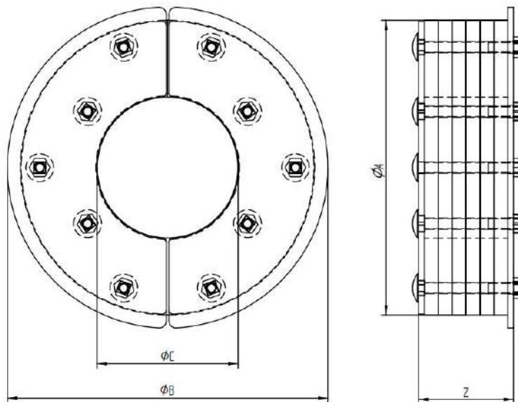
$\varnothing A-B$  depende del diámetro interno del tubo. -  $\varnothing C$  depende del tamaño de los cables.
