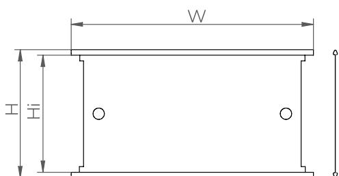
→ **Placa de separación de alta presión HTS**
