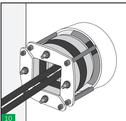
La extracción se logra liberando la compresión, es decir, invirtiendo pasos 6-7-8 y atornillando tornillos M8 (no suministrado) en los agujeros roscados en cada esquina de las placas frontales. Esto libera el montaje desde la abertura y permite desarmar el sistema.
