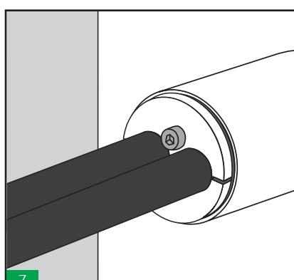
7 Realizar una inspección visual del paso. El HRST seleccionado coincide con la tubería y el casquillo instalado (código de color). El HRST esta completamente insertado en el casquillo, no existen brechas entre HRST y el cable/tubería.
