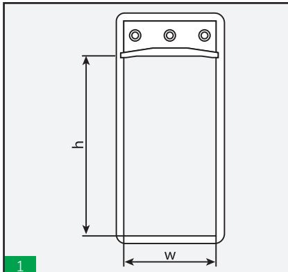
**1** Antes de usar la herramienta de compresión, es importante verificar que el área de sellado que indica el tamaño del marco esté completamente llena de tacos. Así, evitamos el apriete excesivo de la herramienta.
