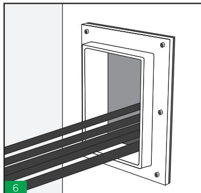
Tire los cables o tuberías a través del marco, ubicando los mas grandes en la parte inferior.
