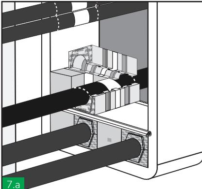
7.a Comenzar a cerrar el marco desde la parte inferior a la superior. Una placa de separación ha de ir siempre entre cada fila de tacos. Los tacos no deben sobrepasar los bordes de retención de las placas de separación. Asegúrese que el cobre de los tacos y los cables coincida. Las marcas en el cable ayudaran a garantizarlo.
