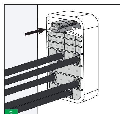
Insertar la ultima fila de tacos entre la placa de separación y la placa de compresión. Insertar la herramienta de compresión sobre la placa de compresión en el centro de esta.
