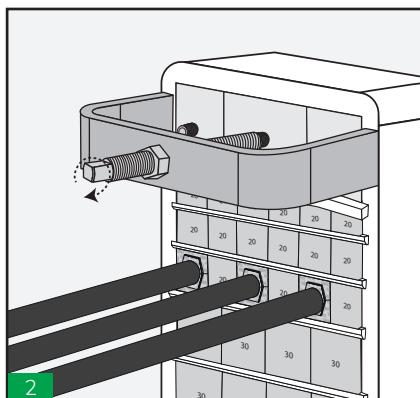
Gire el tornillo del Puller en sentido de las agujas del reloj hasta que esté completamente atornillado en el centro de la empaquetadura.
