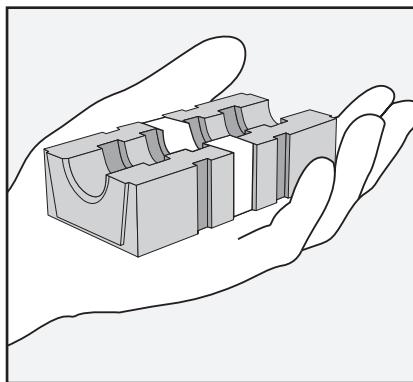
Mida el diámetro exterior del cable y asegúrese de que esté dentro del rango de sellado del taco marcado en la parte frontal del taco.
