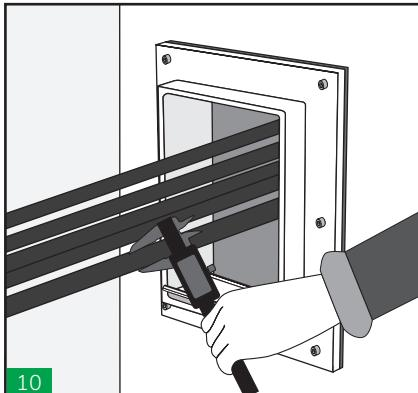
10 Tome medidas de los cables con un calibre y seleccione el taco HTS apropiado. La guía de colores le ayudara a seleccionar el correcto. Únicamente usar tacos H-DM.
