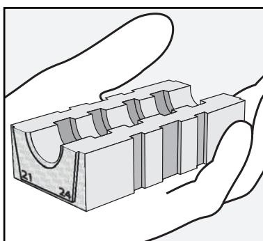
Medir el diámetro exterior del cable y asegurarse que el diámetro del cable/tubería entra dentro del rango marcado en la parte frontal del taco o asegurarse mediante el código de colores de los tacos.
