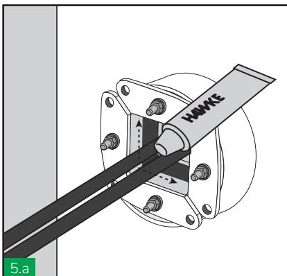
5 Lubricar el interior del HRTO, los tacos ciegos y los pasacable a usar con el lubricante HTS. Abrir las dos chapas frontales (las chapas frontales de los: HRTO30, HRTO40 & HRTO50 son fijas).
