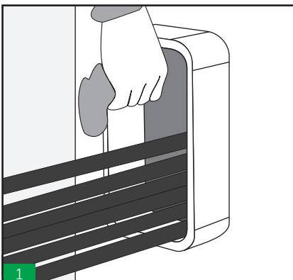
1 Asegúrese que el marco este limpio, pase los cables y tuberías a través del marco, ubicando los de mayor diámetro en la parte baja. (Nota: Emplear marco abierto para adaptar instalaciones ya existentes)
