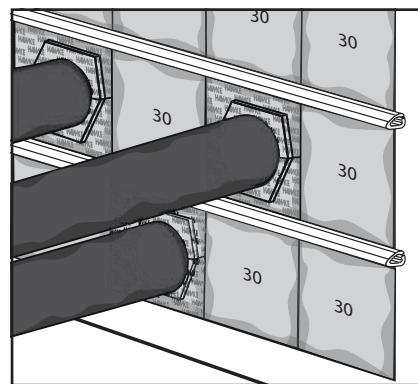
Comprobar que hay suficientes tacos instalados dentro del marco para cubrir el área de sellado definido por el tamaño del marco.
