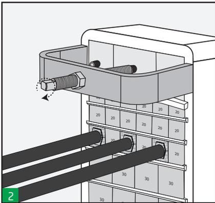
Avvitare la femmina del tirante dell'estrattore sulla vite dell'elemento centrale del modulo terminale agendo con una chiave sulla sua estremità libera.
