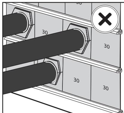
Verificare la presenza di una piastra di ancoraggio tra ciascuna fila di blocchetti e che non ci siano piastre di ancoraggio tra la fila di fondo e il telaio.
