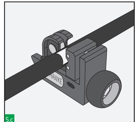
L'attrezzo di rimozione della guaina del cavo EMC può aiutarvi a ridurre i tempi ed evitare di danneggiare lo schermo del cavo durante il taglio.
