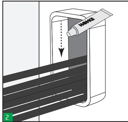
2 Lubrificare l'interno del telaio. Assicurarsi che gli angoli siano ben lubrificati.
