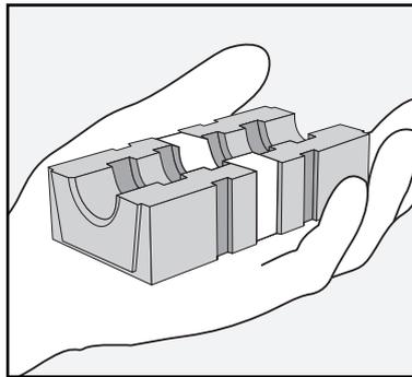
Misurare il diametro esterno del cavo e assicurarsi che rientri nella gamma di diametri indicata sulla parte anteriore del blocchetto o dal codice colore del blocchetto.
