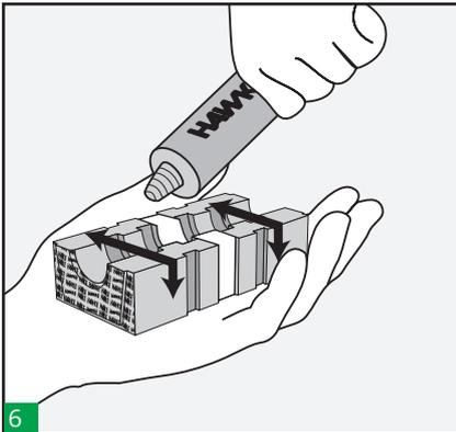
**6** Lubrificare leggermente tutti i blocchetti tolleranti e di riempimento usando il lubrificante Hawke e facendo attenzione a non contaminare il rame sui blocchetti e sui cavi.
