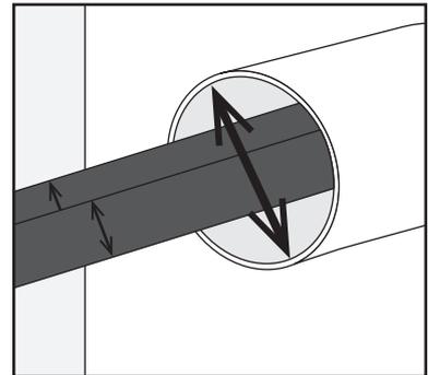
Verificare che il passaggio HRST sia completamente inserito nel manicotto/apertura.
