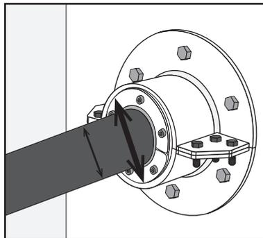
Verificare il diametro interno del manicotto e il diametro esterno del cavo/ tubo per verificare che rientri nell'intervallo del passaggio HRST selezionato.
