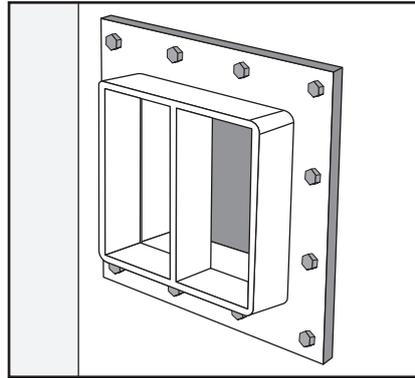
Verificare che nell'installazione sia stato usato un Telaio Hawke, che sia stato installato correttamente (saldato/ imbullonato) e che non abbia subito danni meccanici o da corrosione.
