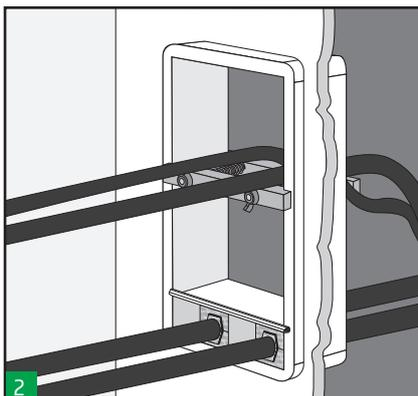
L'attrezzo di fissaggio può essere usato per tenere bloccati sulla parte superiore del passaggio i cavi dei successivi strati permettendo un'installazione più facile dei blocchetti strato per strato.
