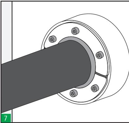
Ispezionare visivamente il passaggio, verificando che il passaggio HRST selezionato (identificato dal codice colore) si abbinì al cavo/tubo e al manicotto installato, che sia completamente inserito nel manicotto e che non ci siano spazi tra il passaggio e il cavo/tubo.
