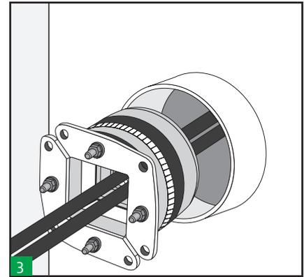
Inserire completamente il passaggio rotondo nel manicotto intorno ai cavi e aprire le due piastre anteriori (le piastre anteriori dei passaggi HRTO30, HRTO40 e HRTO50 sono fisse). Non applicare lubrificante sull'apertura o al di fuori del manicotto.
