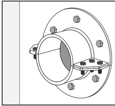
Verificare che nell'installazione sia stato usato un Manicotto Hawke, e che sia stato installato correttamente (saldato/ imbullonato) e che non abbia subito danni meccanici o da corrosione.
