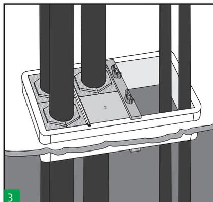
L'attrezzo agevola l'installazione di un passaggio orizzontale, mantenendo i blocchetti in posizione ed evitandone la caduta.
