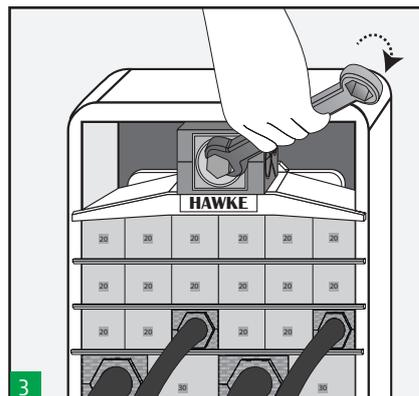
3 Una volta centrato, iniziare ad avvitare l'attrezzo di compressione che spingerà sulla piastra di compressione.
