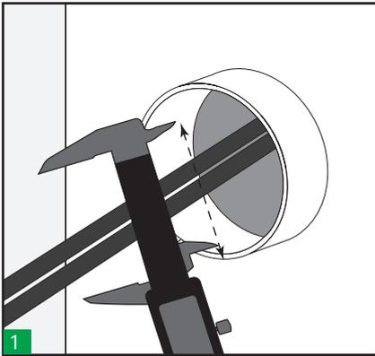
Misurare l'interno del manicotto per assicurare che rientri nel campo di tolleranza del passaggio rotondo da usare.
