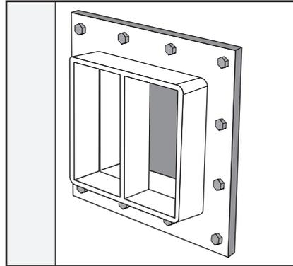
Verificare che nell'installazione sia stato usato un Telaio Hawke, e che sia stato installato correttamente (saldato/ imbullonato) e che non abbia subito danni meccanici o da corrosione.
