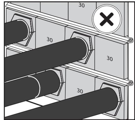
Verificare che sia stato usato il lubrificante Hawke durante l'installazione.
