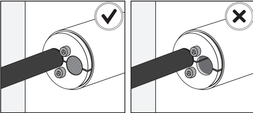
Verificare che ogni foro libero del passaggio HRST sia stato chiuso con tappi HRST Hawke.
