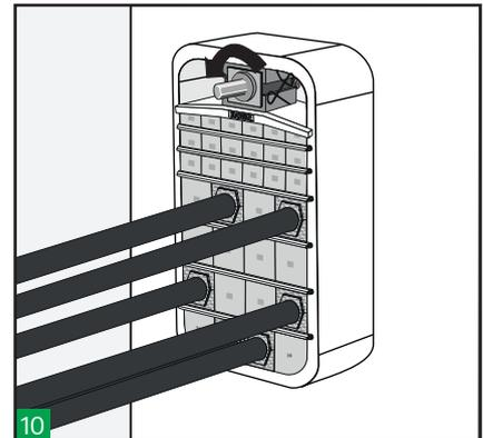
**10** Avvitare lo strumento di compressione fino a quando ci sia spazio sufficiente per inserire gli elementi esterni del modulo terminale.
