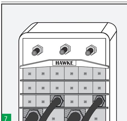
7 Stringere i dadi sul modulo terminale in maniera alternata seguendo la sequenza sopra indicata per comprimere il passaggio e garantire la tenuta. Per un'installazione più facile, usare una chiave a cricchetto. Per assicurare la tenuta, dovrebbero fuoriuscire circa 10-12mm di filettatura da ogni bullone.
