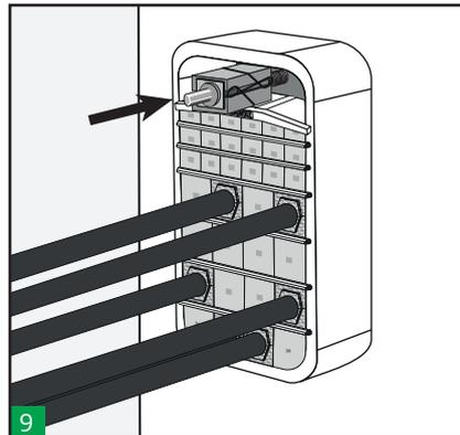
**9** Inserire l'ultima fila tra l'ultima piastra di ancoraggio e la piastra di compressione. Inserire l'attrezzo di compressione in cima, al centro della piastra di compressione.
