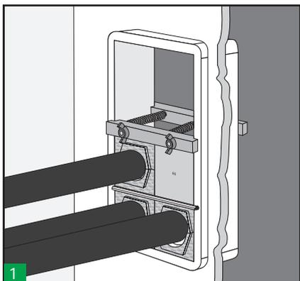
L'attrezzo di fissaggio può essere usato per tenere i blocchetti in posizione quando l'installazione del passaggio deve essere interrotta prima del completamento.
