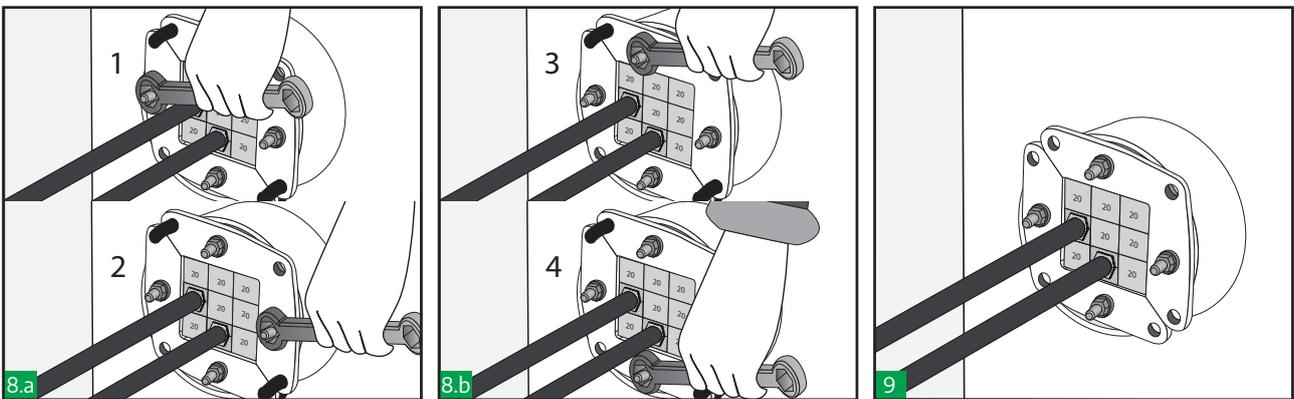
Stringere i dadi di circa 2 mm a ogni passata in maniera alternata, applicando uguale pressione a entrambe le piastre. Dovrebbe fuoriuscire un minimo di 10 mm di filettatura da ogni bullone. Per un'installazione più facile, usare una chiave a cricchetto.
