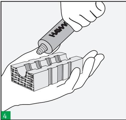
4 Lubrificare la superficie di tutti i blocchetti tolleranti e di riempimento usando il lubrificante Hawke.
