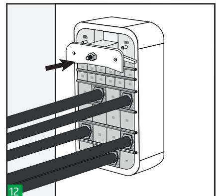
**12** Inserire l'elemento centrale del modulo terminale insieme alla piastra anteriore.
