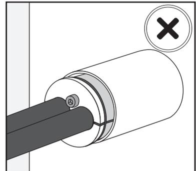
Verificare che sia stato usato il lubrificante Hawke durante l'installazione.
