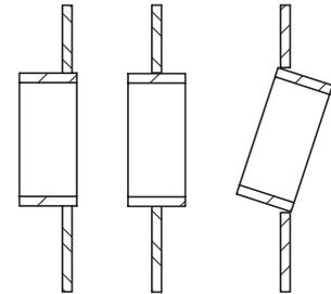
2. Saldare a punti sul lato anteriore, centrando il telaio sul foro pretagliato:
