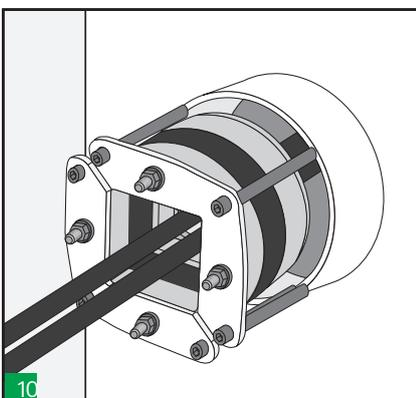
L'estrazione si ottiene rilasciando la compressione, ossia invertendo i passaggi 7 e 8 e avvitando viti M8 (non fornite) nei fori filettati su ogni angolo delle piastre anteriori. In questo modo si estrae il passaggio dal manicotto permettendo lo smontaggio.
