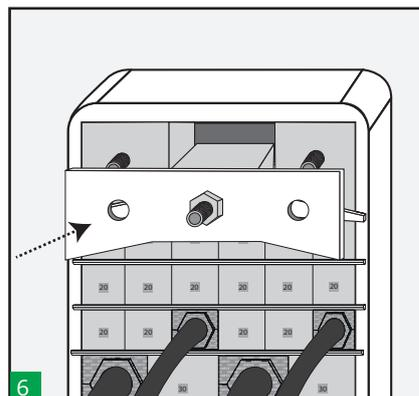
6 Inserire l'elemento centrale del modulo terminale insieme alla piastra anteriore.
