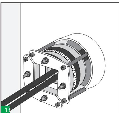
L'estrazione si ottiene rilasciando la compressione, ossia invertendo i passaggi 10 e 11 e avvitando viti M8 (non fornite) nei fori filettati su ogni angolo delle piastre anteriori. In questo modo si estrae il passaggio dal manicotto permettendo lo smontaggio.
