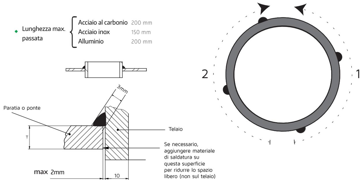
$$\text{Input di calore (KJ/mm)} = \frac{V \cdot I \cdot \eta}{\text{vel} \cdot 1000}$$
