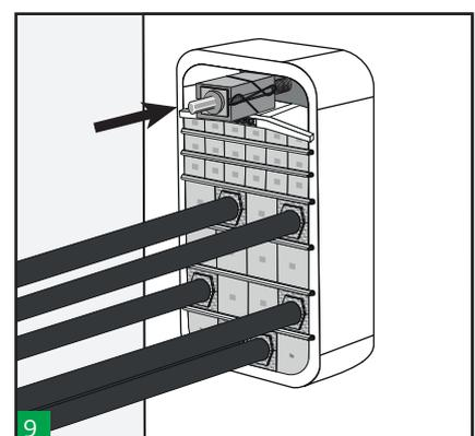
9 Inserire l'ultima fila di blocchetti tra l'ultima piastra di ancoraggio e la piastra di compressione. Inserire l'attrezzo di compressione sopra la piastra di compressione, al centro.
