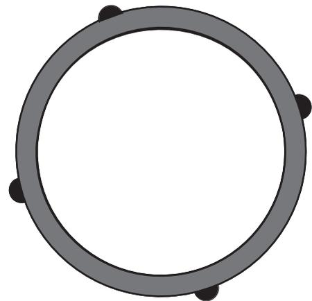
3. Iniziare a saldare il telaio con una saldatura ad angolo sigillante sul lato posteriore. Seguire la sequenza di saldatura appropriata. La gola di saldatura non dovrebbe superare i 3mm.
