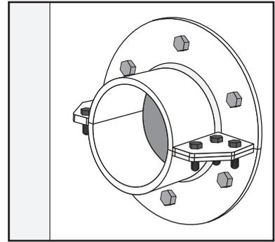
Verificare il diametro interno del manicotto e il diametro esterno di ciascun cavo/tubo per verificare che rientri nell'intervallo del passaggio HRST selezionato.
