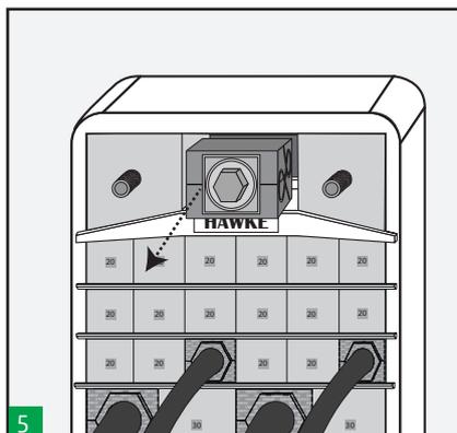
5 Inserire gli elementi laterali del modulo terminale. Successivamente, svitare l'attrezzo di compressione e rimuoverlo.
