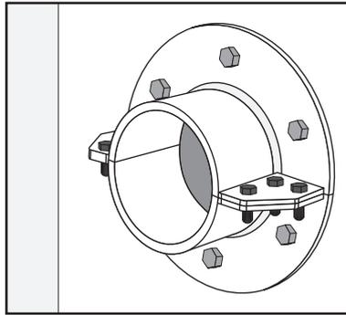
Verificare che nell'installazione sia stato usato un Manicotto Hawke, che sia stato installato correttamente (saldato/ imbullonato) e che non abbia subito danni meccanici o da corrosione.
