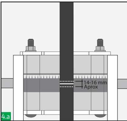
Marcare ogni cavo in corrispondenza del centro del telaio e 7-8 mm su ogni lato da questo punto. Si raccomanda inoltre di marcare il cavo su entrambe le estremità del telaio.
