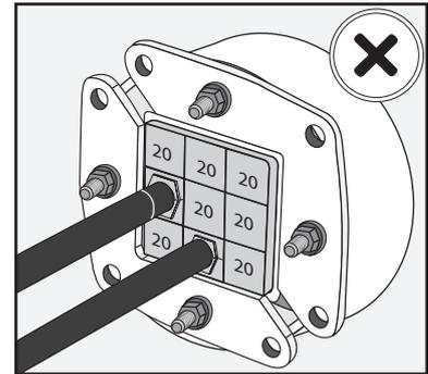
Verificare che ci sia un numero sufficiente di blocchetti installati all'interno del telaio per coprire l'area utile definita per ogni misura di passaggio.
