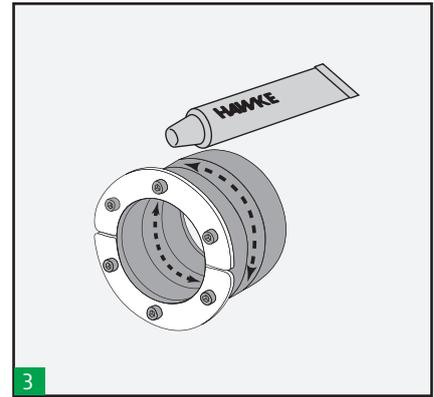
3 Lubrificare l'interno del passaggio HRST a contatto con il cavo/tubo e lubrificare leggermente la parte esterna a contatto con il manicotto.
