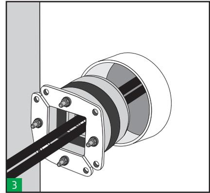
3 Führen Sie den runden Durchführungsrahmen vollständig in den Rundrahmen bzw. Öffnung um die Kabel herum ein und lösen Sie die beiden Frontplatten. Schmiermittel darf nicht auf die Innenseite der Öffnung oder die Außenseite des Rahmens aufgetragen werden. Wenn eine geschlossene Ausführung der Runddurchführung (HRT) verwendet wird, muss sie zuerst installiert werden, um dann die Kabel bzw. Rohre durch die Runddurchführung und den Rundrahmen/Öffnung ziehen zu können.
