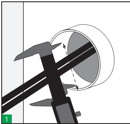
1 Messen Sie den Innendurchmesser des Rohres/ der Öffnung, um sicherzustellen, dass er innerhalb des Toleranzbereiches der zu verwendenden Runddurchführung liegt.
