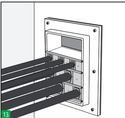
13 Zwischen den einzelnen Modulschichten wird immer eine Verankerungsscheibe eingefügt.
