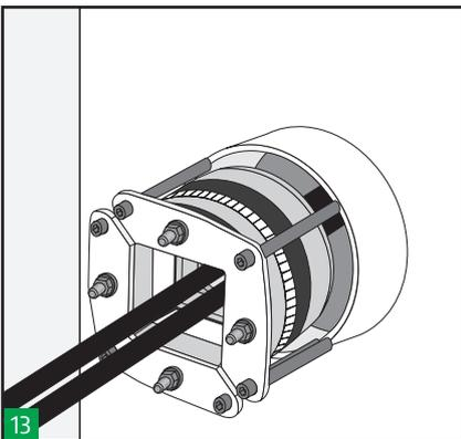
Die Demontage erfolgt durch Lösen der Kompression, d. h. durch Umkehren der Schritte 5 und 6 und Einschrauben von M8-Schrauben (nicht mitgeliefert) in die Gewindebohrungen an jeder Ecke der Frontplatten. Dadurch wird die Runddurchführung von der Öffnung abgedrückt und das System kann demontiert werden.
