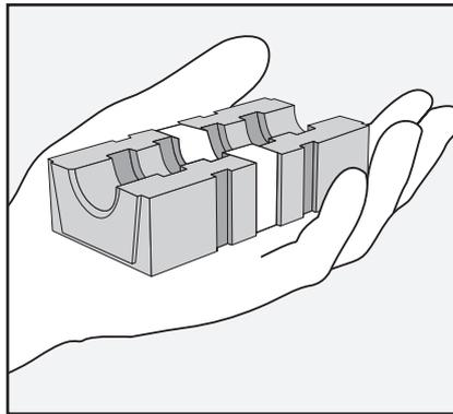
Messen Sie den Außendurchmesser des Kabels und vergewissern Sie sich, dass der Durchmesser innerhalb des Toleranzbereichs liegt, der auf der Vorderseite des Moduls oder durch den Farbcode des Moduls angegeben ist.
