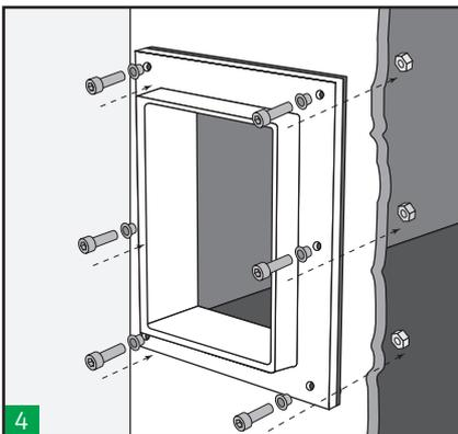
4 Setzen Sie die Schrauben, Unterlegscheiben und Muttern in den Rahmen bzw. den Schrank ein.
