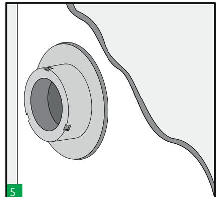
Ziehen Sie beide Teile fest an. Verwenden Sie bei Bedarf einen Haken- oder Hakenschlüssel. Entfernen Sie überschüssiges Silikon, sobald alles festgezogen ist.
