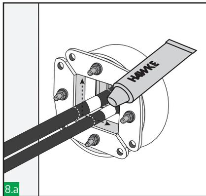
Schmieren Sie die Innenseite der HRTO-Runddurchführung und alle Toleranz- und Füllmodule mit Hawke-Schmiermittel ein. Achten Sie dabei darauf, dass das Kupferband nicht verunreinigt wird.
