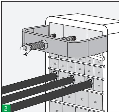
Setzen Sie das Ausziehwerkzeug so auf den Rahmen, dass das Innengewinde seines Bolzens auf der Schraube des mittleren Moduls der Endabdichtung liegt.
