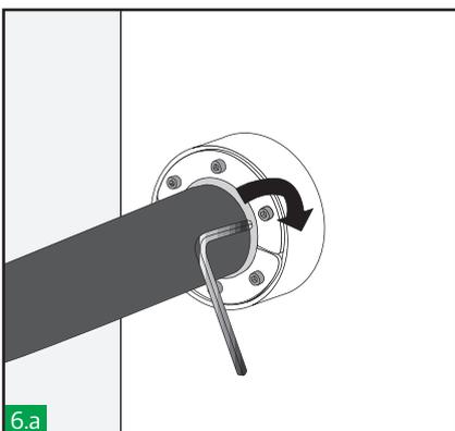
Ziehen Sie die Schrauben an. Das Anziehen besteht aus jeweils einer Umdrehung pro Schraube und muss Schritt für Schritt immer wieder in der angegebenen Reihenfolge erfolgen, bis das System ausreichend komprimiert ist, um das Kabel oder Rohr abzudichten.
