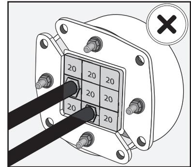
Prüfen Sie, ob im Rahmen genügend Module für den jeweiligen Dichtungsbereich der einzelnen Rahmengrößen eingesetzt sind.
