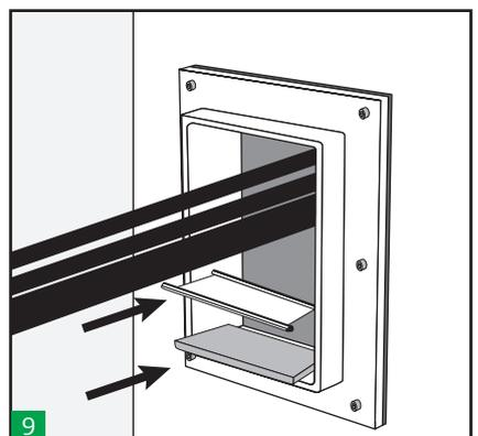
9 Vor Beginn des Packens legen Sie eine 5 mm dicke Zwischenplatte mit einer Verankerungsscheibe am unteren Rand des Rahmens ein. Sie sind im Kompressionssystem enthalten.
