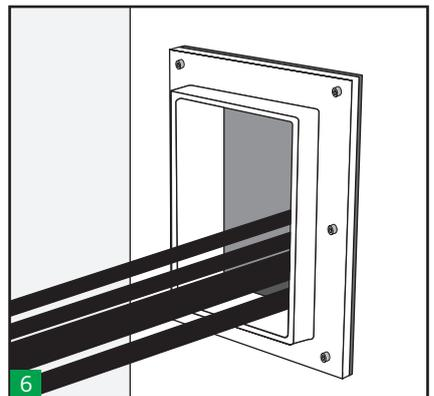
6 Ziehen Sie die Kabel oder Röhre durch und achten Sie darauf, dass der größte Durchmesser unten liegt.
