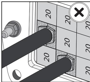
Überprüfen Sie die korrekte Ausrichtung der Module.
