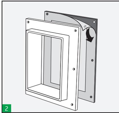
2 Entfernen Sie die Schutzfolie und kleben Sie die Dichtung auf den Aluminiumrahmen.
