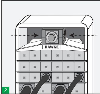
Das Kompressionswerkzeug muss sowohl in Längs- als auch in Querrichtung zentriert in den Rahmen eingeführt werden, da sonst kein gleichmäßiger Druck im System aufgebaut werden kann und das Werkzeug vor dem Einführen der seitlichen Module der Endabdichtung zu stark angezogen werden müsste und beschädigt werden könnte.
