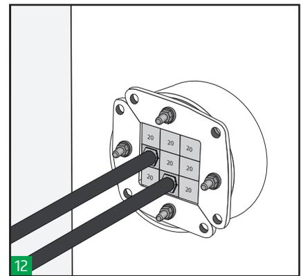
Ziehen Sie die Muttern abwechselnd jeweils ca. 2 mm an und üben Sie dabei auf beide Platten denselben Druck aus. An jeder Schraube müssen abschließend mindestens 10 mm des Gewindes herausragen. Eine Umschaltknarre erleichtert den Einbau.
