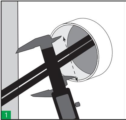
1 Messen Sie den Innendurchmesser des Rohres/Öffnung, um sicherzustellen, dass er innerhalb des Toleranzbereiches der zu verwendenden Runddurchführung liegt.
