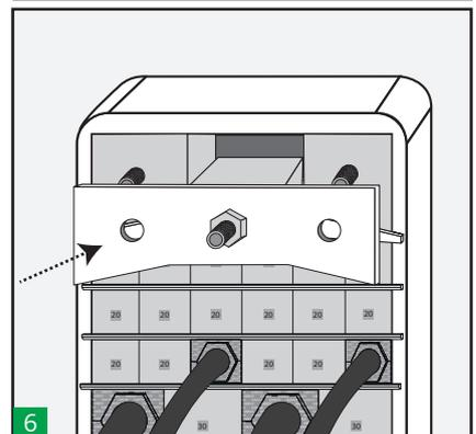
Setzen Sie das Mittelstück der Endabdichtung zusammen mit der Frontplatte ein.
