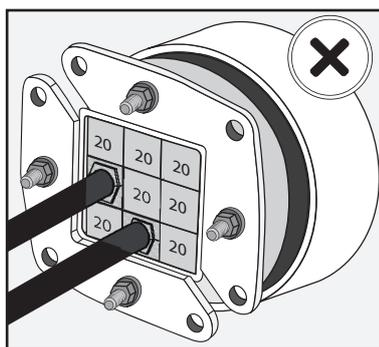
Überprüfen Sie, ob die HRT/HRTO-Runddurchführung vollständig in den Rundrahmen/ Öffnung eingesetzt ist.
