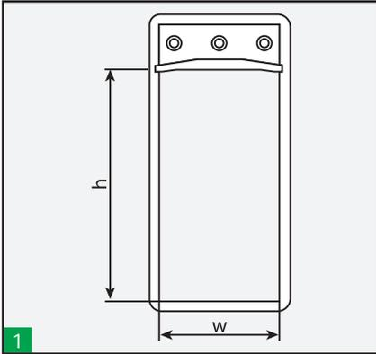
Vor Verwendung des Kompressionswerkzeugs ist zu prüfen, ob der gesamte Dichtungsbereich der gewählten Rahmengröße (siehe Tabelle) mit Modulen gefüllt ist. Damit soll ein Überdrehen des Werkzeugs verhindert werden.
