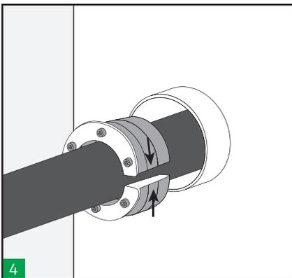
Öffnen Sie die HRST-Runddurchführung und installieren Sie sie um das Kabel oder Rohr herum.
