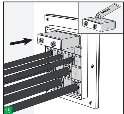
15 Die letzte Modulreihe wird zwischen den beiden letzten Verankerungsscheiben eingesetzt. Schmieren Sie die H-DM-Endabdichtung ein und setzen Sie sie oben am Rahmen ein.
