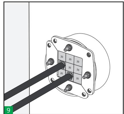
Ziehen Sie die Muttern abwechselnd jeweils ca. 2 mm an und üben Sie dabei auf beide Platten den gleichen Druck aus. An jeder Schraube müssen mindestens 10 mm des Gewindes herausragen. Eine Umschaltknarre erleichtert den Einbau.
