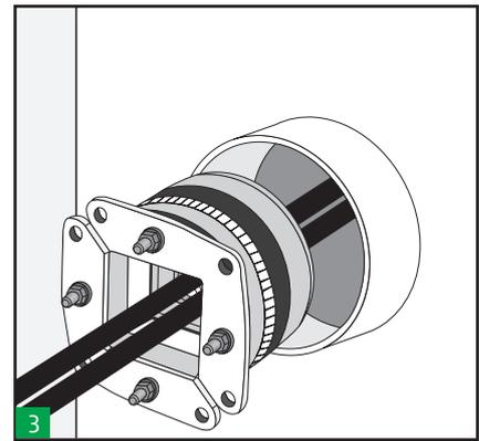
3 Führen Sie den runden Durchführungrahmen vollständig in den Rundrahmen bzw. die Öffnung um die Kabel herum ein und lösen Sie die beiden Frontplatten. Schmiermittel darf nicht auf die Innenseite der Öffnung oder die Außenseite des Rahmens aufgetragen werden. Wenn eine geschlossene Ausführung der Runddurchführung (HRT) verwendet wird, muss sie zuerst installiert werden, um dann die Kabel bzw. Rohre durch die Runddurchführung und den Rundrahmen/ Öffnung ziehen zu können.
