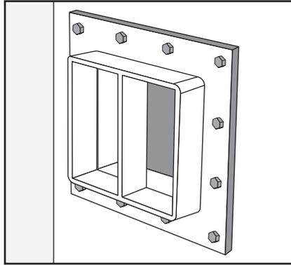
Prüfen Sie, ob ein Hawke-Rahmen für die Installation verwendet wurde, ob er ordnungsgemäß installiert (geschweißt oder verschraubt) wurde und keine mechanischen oder Korrosionsschäden aufweist.
