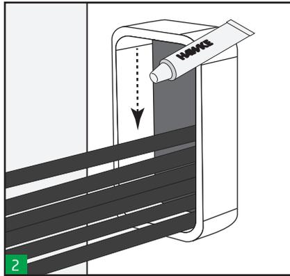
Schmieren Sie die Innenseite des Rahmens. Stellen Sie sicher, dass die Ecken gut eingeschmiert sind.
