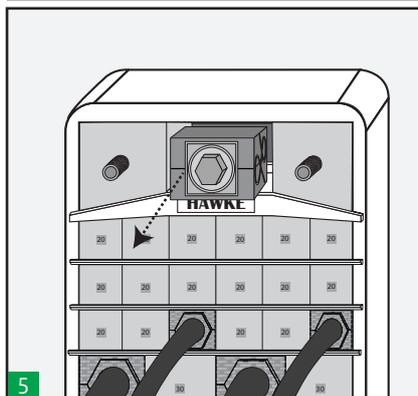
Setzen Sie die äußeren Module der Endabdichtung ein. Lösen Sie dann das Kompressionswerkzeug und entfernen Sie es.
