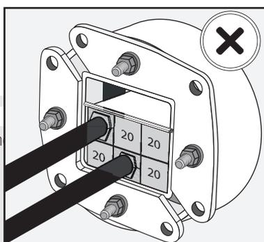
Stellen Sie sicher, dass beim Einbau keine Verankerungsscheiben verwendet wurden.
