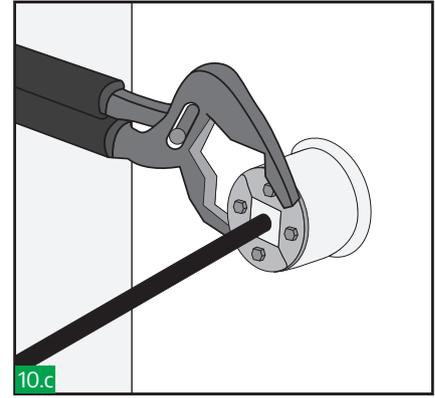
Schieben Sie die beiden Frontplatten zusammen und halten Sie sie fest zusammen. Stellen Sie sicher, dass sich alle Module an der Innenseite des vorderen Haltewulsts befinden. Zur Unterstützung können zum Schließen der Platte Kabelbinder, Bolzen oder verstellbare Zangen verwendet werden.
