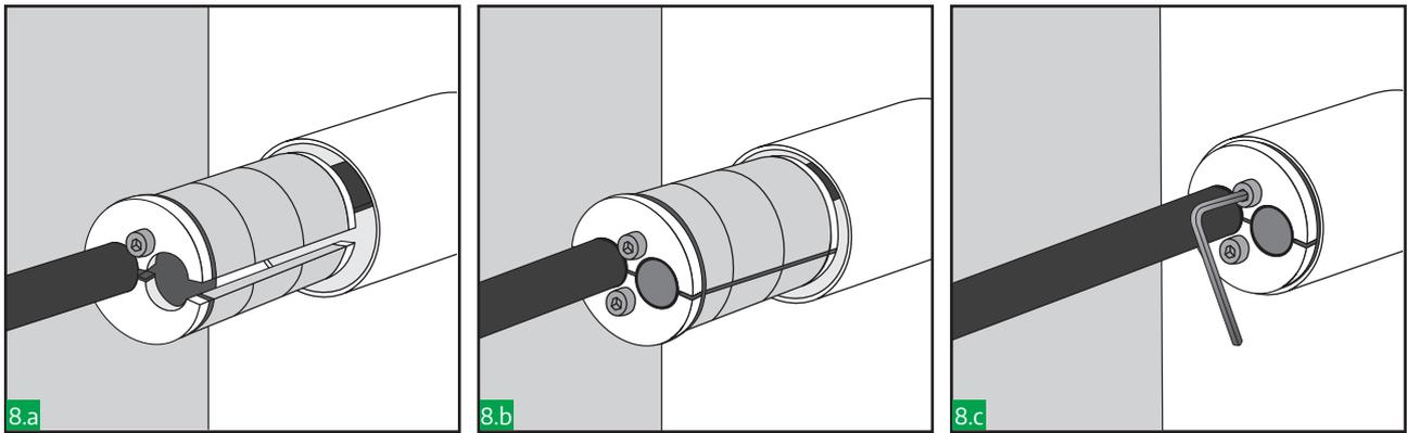
Wenn eine HRST-Runddurchführung nicht mit Kabeln belegt ist, muss sie mit dem passenden Stopfen verschlossen werden.
