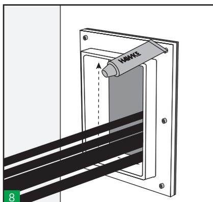
8 Schmieren Sie die Innenseite des Rahmens. Stellen Sie sicher, dass die Ecken gut eingeschmiert sind.
