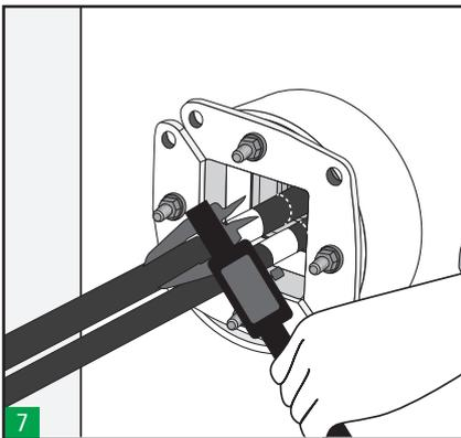
Messen Sie die Kabeldurchmesser und wählen Sie die geeigneten Hawke-Toleranzmodule aus.
