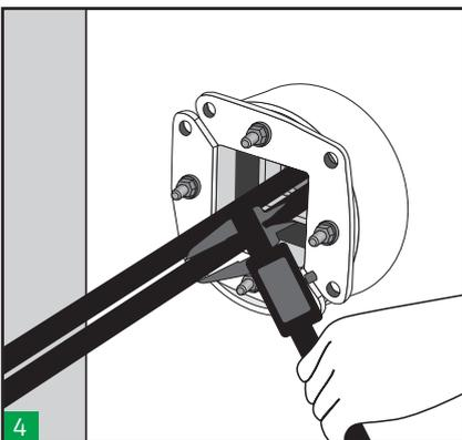
4 Messen Sie die Kabeldurchmesser und wählen Sie die geeigneten Hawke-Toleranzmodule aus. Der Farbcode unterstützt Sie bei der Auswahl der passenden Module.
