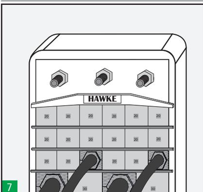
Ziehen Sie die Muttern an der Endabdichtung abwechselnd in der oben angegebenen Reihenfolge an, um die Dichtung zusammenzudrücken und damit eine vollständige Dichtheit herzustellen. Eine Umschaltknarre erleichtert den Einbau. Etwa 10-12 mm des Gewindes sollten an jeder Schraube hervorstehen, damit die Dichtheit gewährleistet ist.
