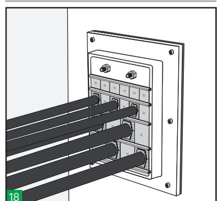
18 Prüfen Sie das Packsystem visuell. Die Hawke-Farbcodierung ermöglicht eine visuelle Überprüfung der Installation nach Fertigstellung und stellt die korrekte Paarung der Modulhälften sicher.
