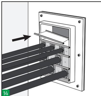
14 Fügen Sie die letzte Verankerungsscheibe vor der letzten Modulreihe ein (oder früher, falls erforderlich). Stellen Sie sicher, dass der gesamte Dichtungsbereich der verwendeten Rahmengröße (siehe Tabelle) mit Modulen gefüllt wird. Hinweis: Die mit dem Kompressionskit mitgelieferte 5 mm dicke Zwischenplatte darf nicht als Teil des Dichtungsbereichs betrachtet werden.
