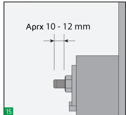
15 Etwa 10-12 mm des Gewindes sollten an jeder Schraube hervorste- hen, damit die Dichtheit gewährleistet ist.
