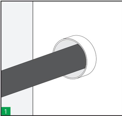
1. Überprüfen Sie den Innendurchmesser des Rundrahmens und den Außendurchmesser des Kabels oder Rohrs, um sicherzustellen, dass er innerhalb des Toleranzbereiches der ausgewählten HRST-Durchführung liegt. Der Hawke HRST-Farbcode hilft bei der richtigen Auswahl.
