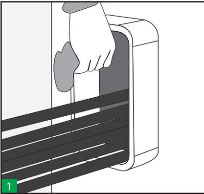
Vergewissern Sie sich, dass der Rahmen sauber ist, und ziehen Sie dann Kabel oder Rohre durch. Der größte Durchmesser muss unten liegen. (Hinweis: Verwenden Sie einen Rahmen mit offenem Ende, um sich um vorhandene Kabel oder Rohre herum einzusetzen.)
