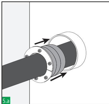
Setzen Sie die HRST-Runddurchführung in den Rundrahmen ein. Vergewissern Sie sich, dass die HRST-Runddurchführung vollständig in den Rundrahmen eingesetzt ist, und dass die Frontplatten Kontakt mit dem Rundrahmen haben.
