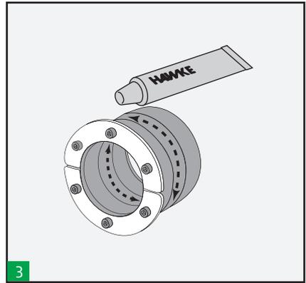
Schmieren Sie die Innenseite der HRST-Runddurchführung für den Kontakt mit dem Kabel bzw. Rohr ein. Schmieren Sie die Außenseiten, die mit dem Rundrahmen in Kontakt kommen, ebenfalls leicht ein.
