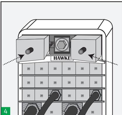
Bevor die Anzugsgrenze erreicht ist, müssen Sie prüfen, ob der Platz zum Einführen der seitlichen Module der Endabdichtung ausreicht, um ein zu starkes Anziehen und damit eine Blockade des Werkzeugs zu vermeiden.
