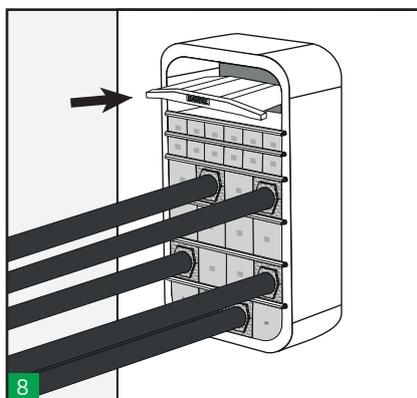
Setzen Sie die letzte Verankerungsscheibe und die Kompressionsplatte vor der letzten Modulreihe ein (oder, falls erforderlich, früher). Prüfen Sie den Dichtungsbereich des Rahmens. Stellen Sie sicher, dass der gesamte Dichtungsbereich dieser Rahmengröße (siehe Tabelle) mit Modulen gefüllt wird.
