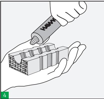
Schmieren Sie alle Sonder- und Füllmodule mit Hawke-Schmiermittel ein.
