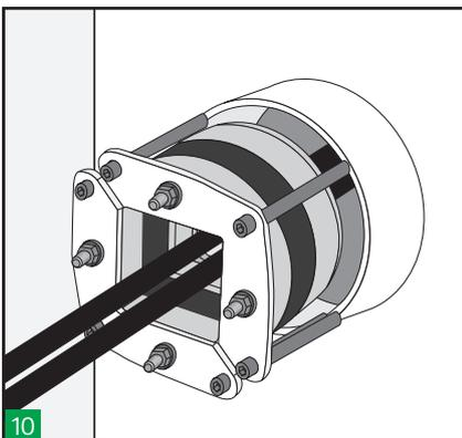
Die Demontage erfolgt durch Lösen der Pressung, d. h. durch Umkehren der Schritte 5 und 6 und Einschrauben von M8-Schrauben (nicht mitgeliefert) in die Gewindebohrungen an jeder Ecke der Frontplatten. Dadurch wird die Runddurchführung von der Öffnung abgedrückt und das System kann demontiert werden.
