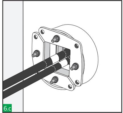
Umwickeln Sie den freigelegten Kabelschirm fest mit Kupferband, bis der Kabelaußendurchmesser wieder erreicht ist. Wiederholen Sie diesen Vorgang für alle Kabel.
