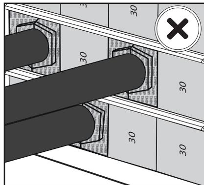
Überprüfen Sie die korrekte Ausrichtung der Module.
