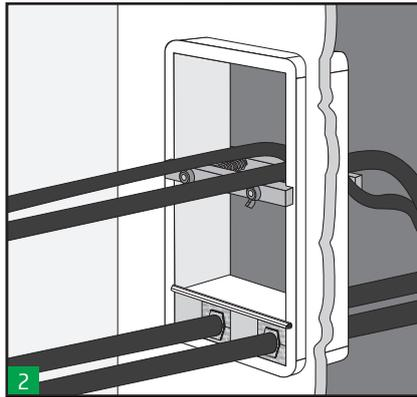
2 Die Rahmenklemme kann verwendet werden, um Kabel im oberen Teil des Rahmens zu halten und so die Installation der Module zu erleichtern.
