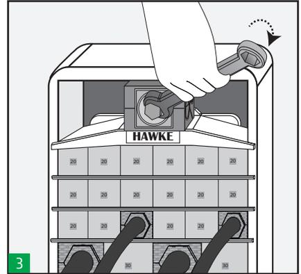
Sobald es zentriert ist, wird das Werkzeug über die Sechskantschraube angezogen und drückt auf die Kompressionsplatte.
