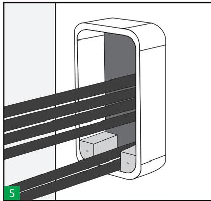
Setzen Sie die mit Eckradien versehenen HF200/R20- oder HF300/R20-Module in die unteren Ecken des Rahmens ein.
