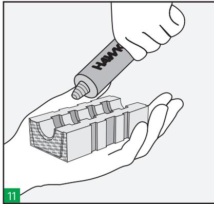
11 Schmieren Sie alle Toleranz- und Füllmodule mit Hawke-Schmiermittel ein.
