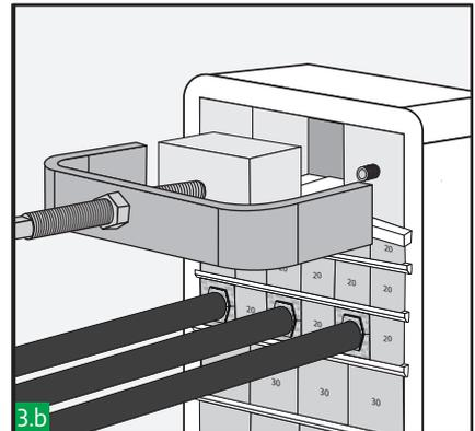
Der Bolzen des Ausziehwerkzeugs wird dann im Uhrzeigersinn gedreht, und das mittlere Modul wird damit aus der Endabdichtung herausgezogen.
