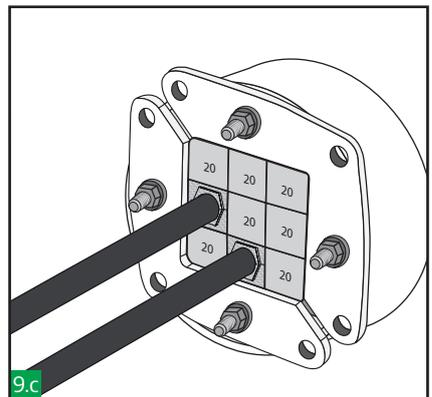
Beginnen Sie mit dem Packen des Durchführungsrahmens von unten nach oben. Stellen Sie sicher, dass die Module fest gegen den hinteren Haltewulst gedrückt werden. Stellen Sie sicher, dass der gesamte Dichtungsbereich des Rahmens (siehe Tabelle für die einzelnen Größen) mit Modulen gefüllt ist.
