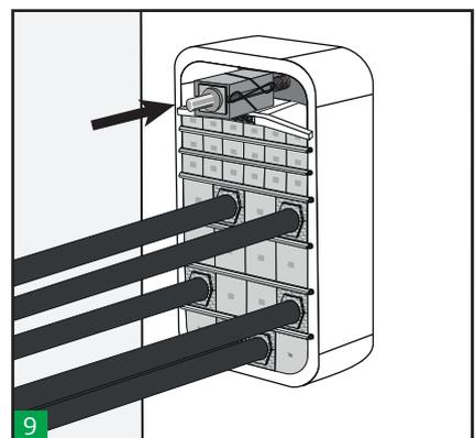
Packen Sie die letzte Reihe zwischen die letzte Verankerungsscheibe und die Kompressionsplatte. Führen Sie das Kompressionswerkzeug mittig oberhalb der Kompressionsplatte ein.
