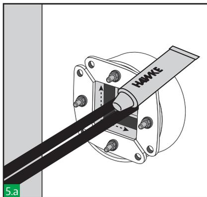
5.a Schmieren Sie die Innenseite der HRTO-Runddurchführung und alle Toleranz- und Füllmodule mit Hawke-Schmiermittel ein. Lösen Sie die beiden Frontplatten. (Die Frontplatten HRTO30, HRTO40 und HRTO50 sind angeschraubt).
