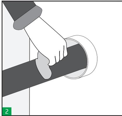
Stellen Sie sicher, dass das Rohr im Rundrahmen genau zentriert ist. Stellen Sie sicher, dass der Rundrahmen und das Kabel bzw. Rohr sauber sind.
