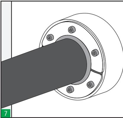
Prüfen Sie die Durchführung visuell. Die HRST-Durchführung (Farbcode) muss passend zum installierten Rohr und dem Rundrahmen ausgewählt sein. Die HRST-Runddurchführung muss vollständig in den Rundrahmen eingesetzt sein, ohne dass zwischen der HRST-Runddurchführung und dem Kabel oder Rohr Spalte vorhanden sind.
