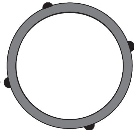
3. Beginnen Sie mit dem Schweißen des Rahmens mit einer Füllnaht auf der Rückseite. Gehen Sie gemäß einer geeigneten Schweißfolge vor. Die Schweißnahtdicke sollte 3 mm nicht überschreiten.
