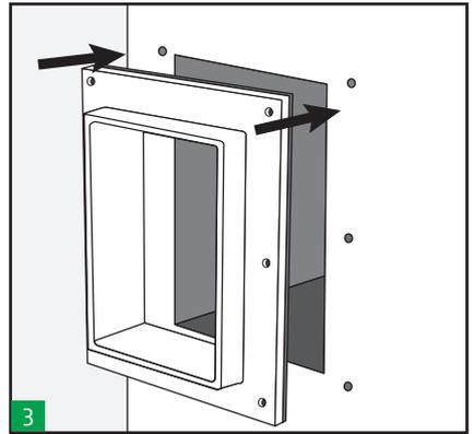
3 Setzen Sie den Rahmen mit der Dichtungsseite auf die Öffnung.
