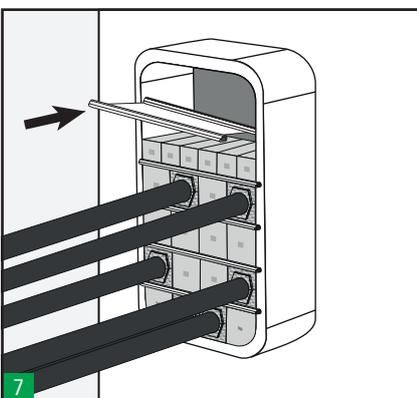
Zwischen den einzelnen Modulschichten wird immer eine Verankerungsscheibe eingefügt. Die Module dürfen nicht über die beiden Haltewülste an den Seiten Verankerungsscheiben hinausragen.
