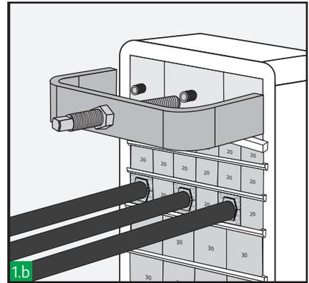
Entfernen Sie die Muttern und die Frontplatte der Endabdichtung.
