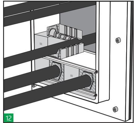
12 Füllen Sie die Packkammer von unten nach oben mit den benötigten Toleranz- und Füllmodulen.
