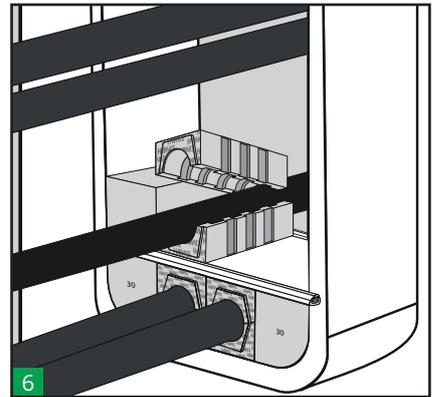
Beginnen Sie mit der Bestückung des Rahmens. Der Farbcode hilft Ihnen beim korrekten Einbau der Module.
