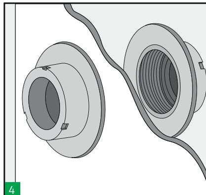
Setzen Sie die Hülse in das vorgeschrittene Loch im Schott ein und beginnen Sie damit, beide Teile festzuziehen.
