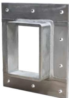
Un cadre HMX standard prolongé par une bague soudée. À utiliser dans les cloisons ondulées ou pour surélever le cadre au-dessus du pont. - **HMEX**
