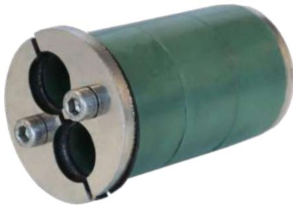
Hawke HRST à trous multiples conçu pour les solutions d'étanchéité de 2 câbles maximum avec un diamètre externe compris entre 10 et 15 mm.
