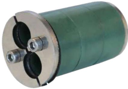
Hawke HRST multiagujero está diseñado para el sellado de hasta 2 cables con un diámetro externo de entre 10mm y 15mm.
