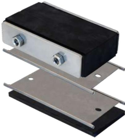
El sistema de compresión CSDM de Hawke se usa junto con los marcos H-DM para comprimir y sellar la instalación de los cables y tacos DM del sistema. Este Kit incluye; la empaquetadura final, tira de relleno de 5mm y dos placas de separación. La tira de relleno de 5mm se puede instalar tanto en la parte superior como en la parte inferior de las filas de tacos en una abertura H-DM.
